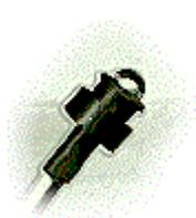
El equipo tiene una diminuta foto resistencia, que se oculta por el tablero; por medio de esta foto resistencia se toman lecturas de luz constantemente, según sean los resultados de esas lecturas, es cuando el AutoLamp encenderá los cuartos, y después encenderá las luces. El tiempo de encendido entre los cuartos y las luces puede variar, dependiendo de la luminosidad; y también a la inversa, primero apagará las luces y después los cuartos.
