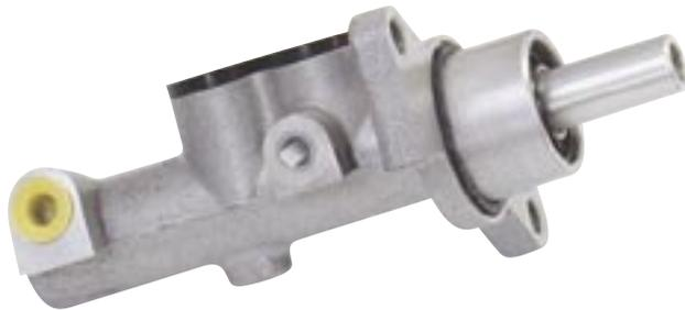
El cilindro principal de freno (cilindro maestro) genera la presión hidráulica en el circuito de freno y controla el proceso de frenado.
