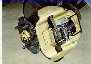
**Freno Girling de mordaza deslizante.** Consta también de un solo cilindro hidráulico en el que se alojan dos pistones. Uno actúa directamente sobre una pastilla de fricción; el otro mueve la mordaza y aplica la segunda pastilla.
