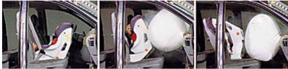
Figura 14: Consecuencias de instalar una silla para niños mirando hacia atrás en el asiento delantero
