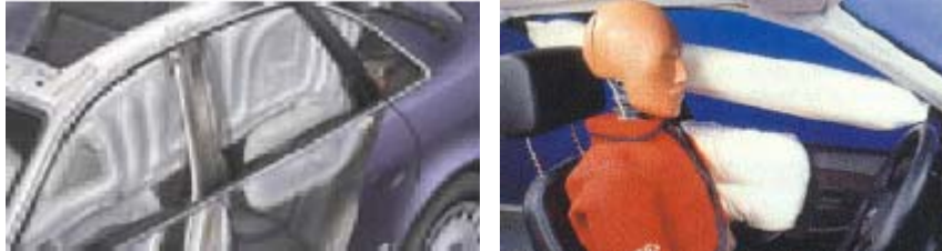
Figura 16: Tipos de airbag para la cabeza: de cortina (izquierda) y tubular (derecha)
