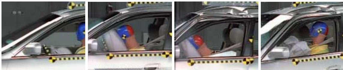
Figura 13: Secuencia de funcionamiento de un airbag frontal
