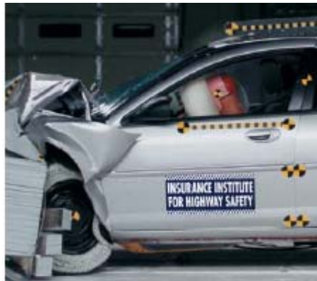
Figura 11: Ejemplo de deformación programada en el sector frontal de un vehículo
