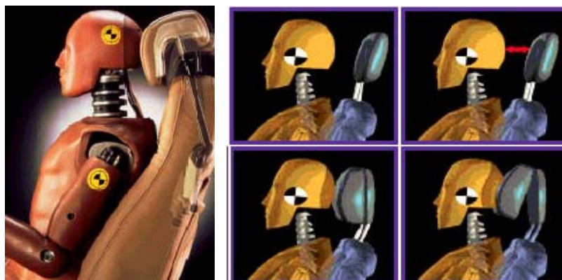
Figura 17: Ejemplos de sistemas de apoyacabezas activos
