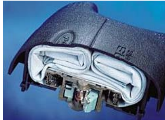
Figura 12: Funcionamiento y plegado de un airbag frontal
