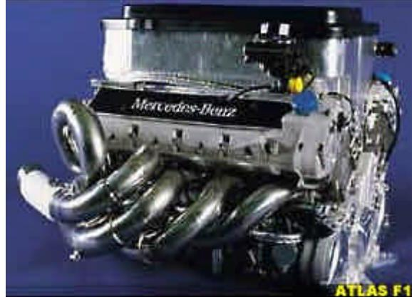
la conexión se hace mediante ordenador, y el "mapeado del motor" básicamente le dice al motor el ángulo del pedal supone que cantidad de mezcla debe entrar en el cilindro. Mediante este sistema, también se puede configurar para la lluvia, con el fin de que el piloto no tenga que cambiar su estilo de pilotaje. Realmente se lo ponen fácil estos días. Pero eso es lo que pensó también la FIA, por lo que han reducido de manera considerable los componentes electrónicos.
