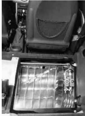
Figura 7. Depósito de combustible del nuevo Mini Cooper
