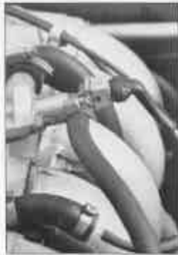
Fig. 2. Válvula de arranque en frío montada en el colector de admisión.
