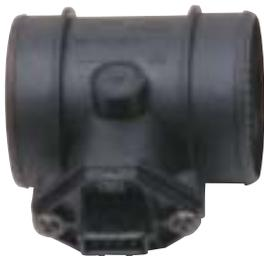
El medidor de masa de aire está instalado entre el filtro de aire y la mariposa, y mide la corriente de masa de aire aspirado. También por esa información, la unidad de comando determina el exacto volumen de combustible para las diferentes condiciones de funcionamiento del motor.
