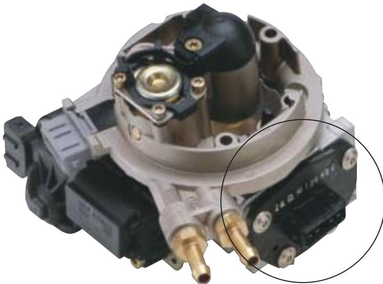
En el sistema mono-motronic (mono punto) el potenciómetro de la mariposa, no se suministra en separado, solamente junto con el cuerpo de la mariposa.
