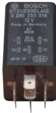
El relé de comando es el responsable por mantener la alimentación eléctrica de la batería para la bomba de combustible y otros componentes del sistema.
