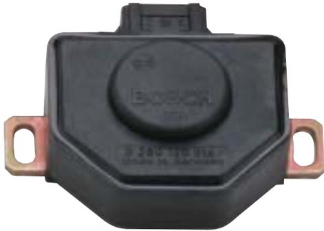
El interruptor está fijado en el cuerpo de la mariposa y se acciona por el eje de aceleración.
