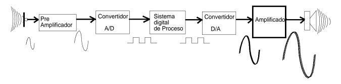
Una vez obtenida la señal por medio de un micrófono la convertimos en digital a través de un **Convertidos Analógico-Digital** para ser introducida en un proceso de sonido y una vez tratada por el **Procesador electrónico**, se volverá a convertir en analógica con el **Convertidor Digital-Analógico** para ser amplificada adecuadamente y ser reproducida por los bafles.
