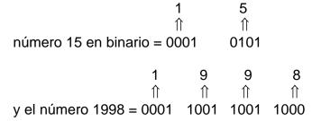
De esta manera la unidad de cálculo (donde se opera) de la calculadora podrá trabajar con conjuntos de señales con tensiones altas y tensiones bajas como hablábamos en el capítulo primero. El componente que transforma un número decimal en tensiones H (1) o en tensiones L (0) y en forma binaria BCD se llama **Codificador**.
