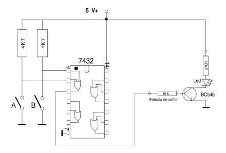
Si quieres hacer bien este montaje debes conectar a masa todas las entradas libres de las puertas que no se usan. De ese modo el integrado no coge "señales espúreas" que además de hacer consumir más corrientes pueden ocasionar comportamientos no deseados del integrado.
