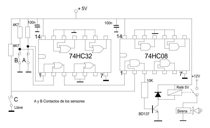
Nota: Los dos condensadores de 100 nF en la alimentación, uno para cada CI , son para el desacoplo de transitorios que se producen en la línea de alimentación, debido a las conmutaciones de los circuitos y el efecto inductivo de la línea. Estos condensadores son típicos en todos los sistemas digitales.
