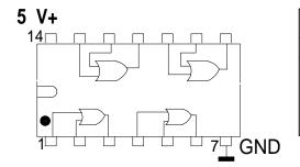
Como puedes observar en el dibujo esquemático, tiene en su interior dibujado cuatro piezas de esta forma y cada una de ellas representa una puerta lógica, por lo que este integrado tendrá cuatro puertas O
