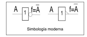
Fíjate que introducimos dos símbolos que usaremos en todas aquellas puertas o funciones que representen "inversión". Es por un lado el circuito o la raya inclinada en la salida y por otro lado el guión que se coloca encima de la letra.
