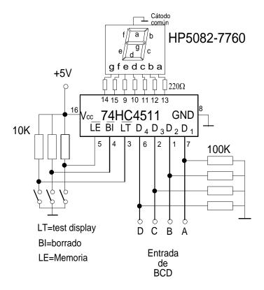
Las entradas de datos BCD están conectadas a una resistencias de 100  $\rm K\Omega$  para fijar a O cuando no reciben datos y no queden al aire, captando ruidos.
