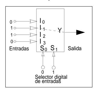
Si aplicamos al terminal  $S_0$  el nivel 1 y a  $S_1$  hacemos que sea 0 entonces el multiplexor seleccionará la entrada  $I_1$ , la cual nos la encontraremos en la salida Y.
