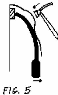
1.4. — COMO TRANCHA, se hace en las palancas cortas con empuñadura, golpeándolas con el martillo de peña o de bola (en la empuñadura), para sacar nervaduras
