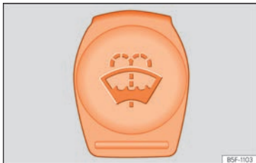
Fig. 204 En el vano motor: tapón del depósito del limpiacristales.
