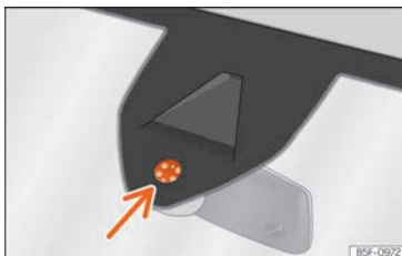
Fig. 105 Superficie sensible del sensor de lluvia.
