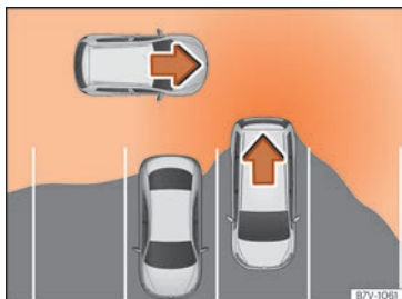
Fig. 167 Representación esquemática del asistente de desaparcamiento: zona vigilada alrededor del vehículo que está desaparcando.
