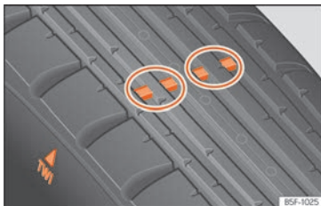
Fig. 207 Perfil del neumático: indicadores de desgaste.
