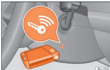
Fig. 137 A la derecha de la columna de dirección: arranque de emergencia.
