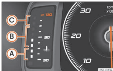
Fig. 73 Cuadro de instrumentos digital: indicador de temperatura del líquido refrigerante del motor.
