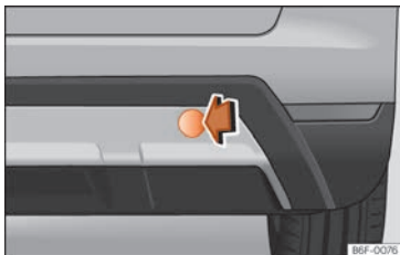
Fig. 46 En el lado derecho del paragolpes trasero: retirar la tapa.
