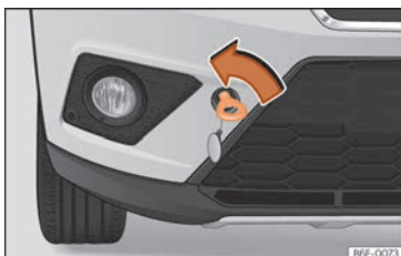
Fig. 45 Parte derecha del parachoques delantero: argolla de remolque enroscada.
