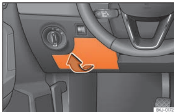
Fig. 48 En el tablero de instrumentos del lado del conductor: tapa de la caja de fusibles.
