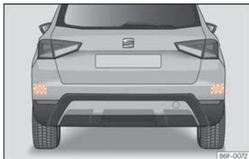
Fig. 147 Vista trasera del vehículo: zonas de los sensores de radar.
