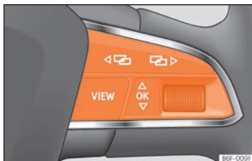
Fig. 74 Lado derecho del volante multifunción: teclas para utilizar los menús y las indicaciones informativas del cuadro de instrumentos.
