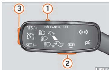
Fig. 154 En la palanca de los intermitentes: teclas para manejar el limitador de velocidad.
