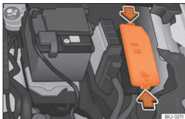
Fig. 49 En el vano motor: tapa de la caja de fusibles.
