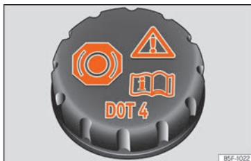
Fig. 203 Vano motor: tapón del depósito del líquido de frenos.
