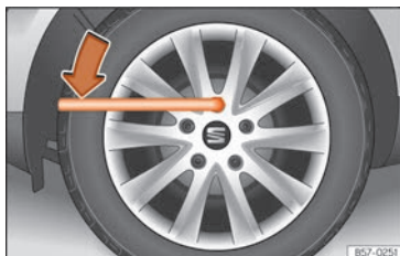
Fig. 35 Cambio de rueda: aflojar los tornillos de rueda.
