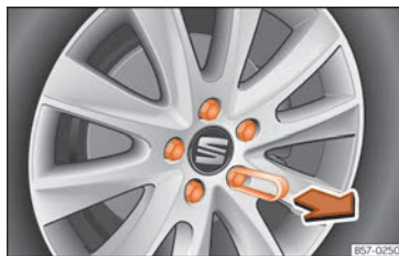
Fig. 33 Rueda: tornillos de la rueda con capuchones.
