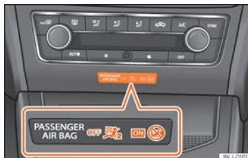
Fig. 17 Parte central del tablero de instrumentos: testigo de control de la desactivación del airbag del acompañante.
