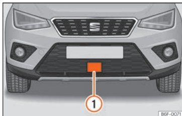
Fig. 145 En el paragolpes delantero: sensor de radar.
