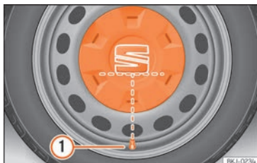
Fig. 32 Colocación correcta del embellecedor central de rueda para llantas de acero.
