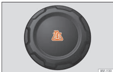
Fig. 202 Vano motor: tapón del depósito de expansión del líquido refrigerante.
