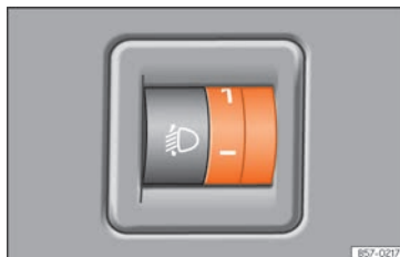
Fig. 101 Al lado del volante: regulador del alcance de las luces.
