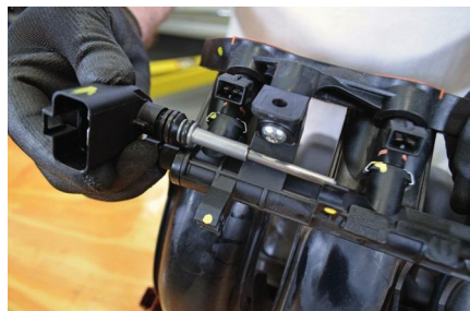
HCSS: cada "heater" (abaixo) fica posicionado em um lado da flauta de combustível
