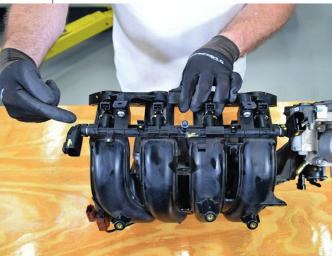
HCSS: cada "heater" (abaixo) fica posicionado em um lado da flauta de combustível
