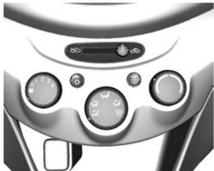
El modo de recirculación del aire se activa con la palanca
