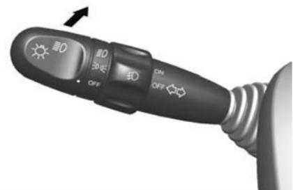
Para cambiar de luces bajas a altas, empuje la palanca.
