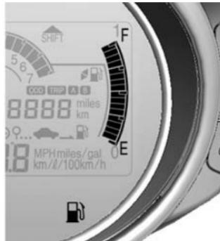
El indicador de control se ilumina si el nivel en el tanque está bajo.
