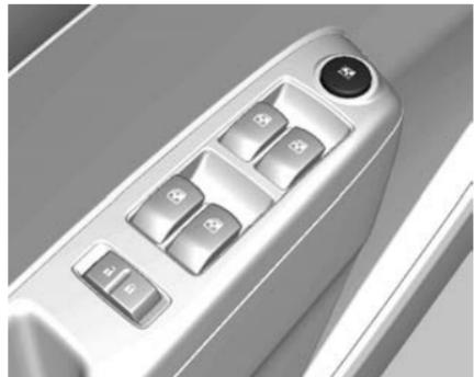
Presione el interruptor para desactivar las ventanas eléctricas traseras.
