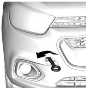
Atornille la argolla de remolque tanto como sea posible hasta que se detenga en una posición horizontal.
