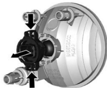
2. Desconecte el conector eléctrico del soporte del foco.
