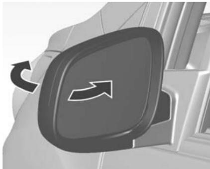
Para seguridad de los peatones, los espejos exteriores se giran fuera de su posición normal de montaje si se golpean con suficiente fuerza.
