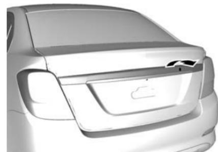
Para abrir la tapa de la cajuela, inserte la llave en la ranura y gírela en sentido de las manecillas del reloj. Levante la tapa de la cajuela.
