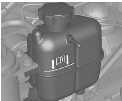
Si el sistema de enfriamiento esta frío, el nivel del refrigerante debería estar arriba de la línea de la marca de llenado. Rellene si el nivel está bajo.
