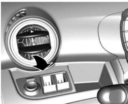
Presione la cubierta de cada salida de aire para abrir las ventilas laterales, y gire a la dirección que deseé.
