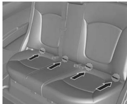
Para instalar un asiento de seguridad para niños que viene equipado con conexiones de anclaje bajo ISOFIX y anclaje superior, siga las instrucciones suministradas con su asiento de seguridad para niños.
