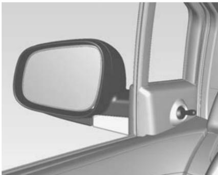
Simplemente mueva la palanca de ajuste en la dirección deseada para ajustar los ángulos de los espejos.
