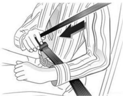
Extraiga el cinturón del retractor, guélo sin retorcer de un extremo al otro del cuerpo e inserte la placa de seguro en la hebilla.
