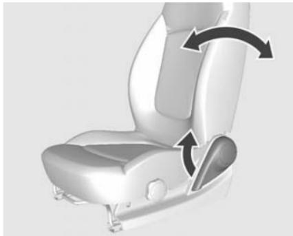
Jale la palanca, ajuste la inclinación y libere la palanca. Permita que se escuche que el asiento engancha.
