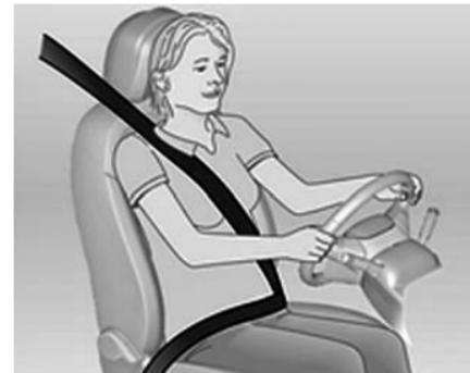
Los cinturones se bloquean durante una aceleración o desaceleración intensa del vehículo para seguridad de los ocupantes.
