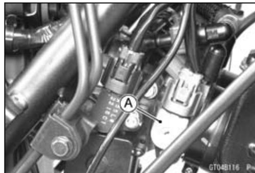
**Inspección del voltaje de entrada del sensor del acelerador**
