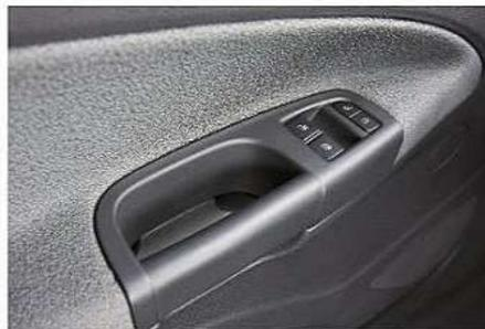
Después de la retirada de la llave del cilindro, la Unidad de Control permite la apertura de los vidrios por 1 minuto
