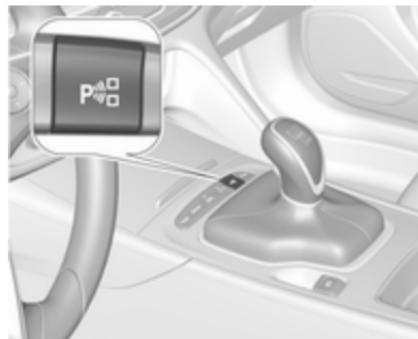
Cuando busque un hueco para aparcar, el sistema está listo para funcionar con una pulsación breve de P<sup>AV</sup>.
