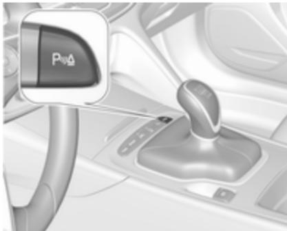
Si está iluminado el LED situado en el botón del asistente de aparcamiento **P/A**, indica que el sistema está listo para funcionar.
