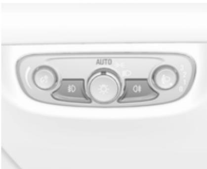
**AUTO** : El control automático de las luces cambia automáticamente entre luces de circulación diurna y faros
