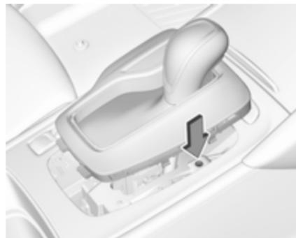
2. Suelte el revestimiento de la palanca selectora de la consola central. Introduzca un dedo en el zócalo de piel junto a la palanca selectora y tire del revestimiento hacia arriba con cuidado, tiene un cable conectado. Deslice el revestimiento ligeramente hacia delante, puesto que está conectado con bisagra en la parte posterior. Incline el revestimiento hacia la izquierda para evitar tensar el cable.
