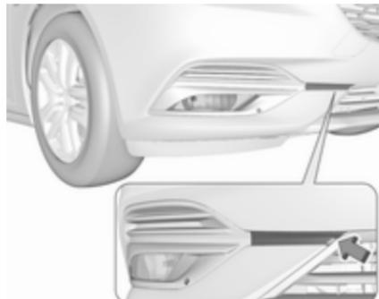
Envuelva un trapo alrededor de la punta de un destornillador plano para evitar dañar la pintura. Introduzca el destornillador en el rebaje del borde de la cubierta. Suelte la cubierta haciendo palanca hacia fuera con cuidado.
