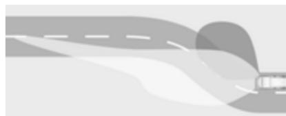
Adicionalmente se activan LED determinados, según el ángulo de dirección y la velocidad, para mejorar la iluminación en curvas. Esta función
