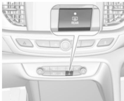
Activado al pulsar junto con los retrovisores exteriores térmicos. El LED del botón se ilumina.
