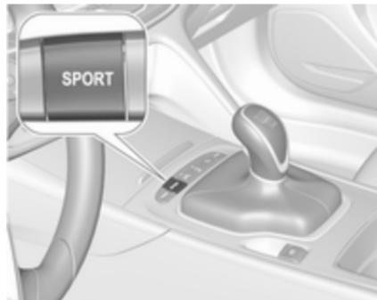
En los vehículos con modos de conducción FlexRide, el conductor puede incrementar ligeramente la aceleración del control de velocidad adaptable cuando se seleccione el modo deportivo. Esta función se puede desactivar en el menú de visualización de Flex Ride ▷ 198
