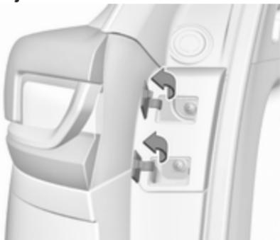
1. Abra las cubiertas con el destornillador. Desenrosque y desmonte los dos tornillos.
