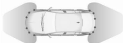
El asistente de aparcamiento avanzado siempre va combinado con el asistente de aparcamiento delantero y trasero. Ambos sistemas utilizan los mismos sensores en los parachoques delantero y trasero.
