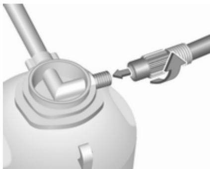
2. **Tipo 1:** enrosque el compresor del tubo de aire en la conexión sobre el bote del sellador y ajuste el bote del sellador en el retén del compresor.
