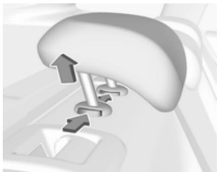
Presione los dos fiadores, tire del reposacabezas hacia arriba y desmóntelo.
