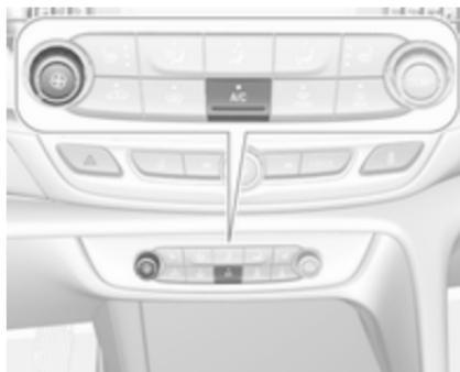
Pulse **A/C** para activar la refrigeración. La activación se indica mediante el LED del botón. La refrigeración sólo funciona con el motor en marcha y el ventilador de climatización conectado.
