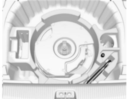
El destornillador y la argolla de remolcado se encuentran debajo de la cubierta del piso en el compartimento de carga, junto al componente redondo del sistema de altavoces.
