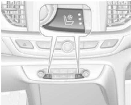
Para ajustar la potencia de ventilación deseada, pulse una o varias veces del asiento delantero correspondiente. El testigo de control en el botón indica el ajuste.
