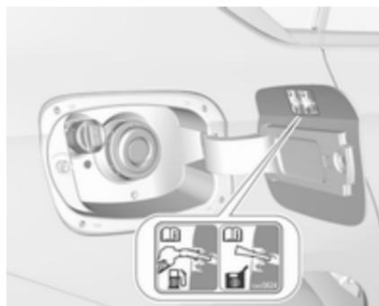
El inhibidor de combustible erróneo garantiza que la tapa de la boca de llenado de combustible solo pueda abrirse usando la boquilla para combustible adecuada o un embudo para repostaje de emergencia.
