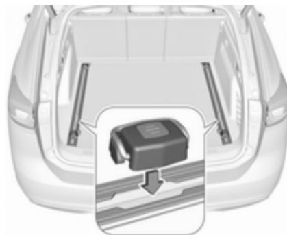
Introduzca los vagones en los raíles del piso del compartimiento de carga. Utilice para ello el rebaje del raíl y pulse el botón del vagón durante la inserción.
