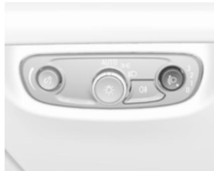
Para adaptar el alcance de los faros a la carga del vehículo y evitar el deslumbramiento: presione y gire
