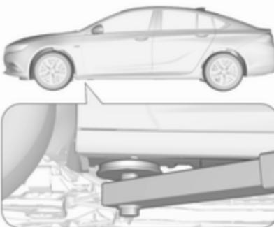
Posición del brazo delantero de la plataforma de elevación centrada debajo del punto de elevación con gato del vehículo correspondiente.
