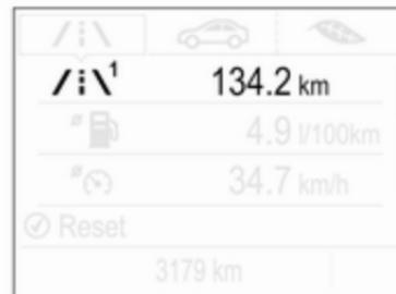
Seleccione **/\** pulsando **Menú** en la palanca de los intermitentes. Gire la rueda de ajuste de la palanca de los intermitentes y seleccione **/\1** o **/\2**. Cada página de cuentakilómetros parcial se puede poner a cero de manera independiente pulsando **SET/CLR** en la palanca de los intermitentes durante unos segundos en el menú correspondiente.
