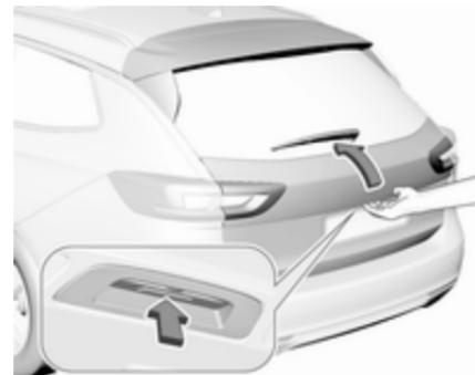
Para abrir el portón trasero, pulse el interruptor de panel táctil situado debajo de la moldura hasta que el portón trasero empiece a moverse. Si el vehículo está bloqueado, la llave electrónica debe estar fuera del vehículo a una distancia máxima de un metro aproximadamente del portón trasero.
