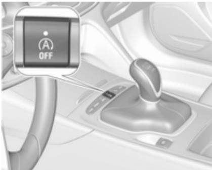
Desactive manualmente el sistema stop-start pulsando . Para indicar la desactivación, se enciende el LED del botón.
