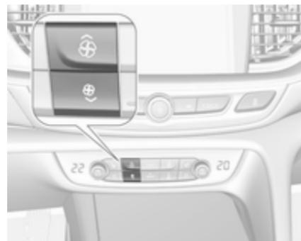
Pulse el botón superior para incrementar o el botón inferior para reducir la velocidad del ventilador. La velocidad del ventilador se indica como mensaje emergente en la pantalla de información. También se puede cambiar la velocidad del ventilador con los botones táctiles en la pantalla de configuración de la climatización. Pulse **Climate** para entrar en el menú.
