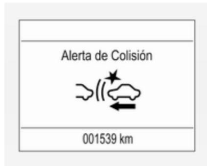
Observe que el ajuste de sensibilidad de la alerta se comparte con el siguiente ajuste de distancia del control de velocidad adaptable. Así, al modificar la sensibilidad de la alarma, cambiará también el ajuste de distancia de seguimiento del control de velocidad adaptable.
