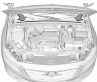
La entrada de aire en el compartimento del motor, delante del parabrisas, debe estar libre para permitir la entrada de aire. Retire cualquier resto de hojas, suciedad o nieve.
