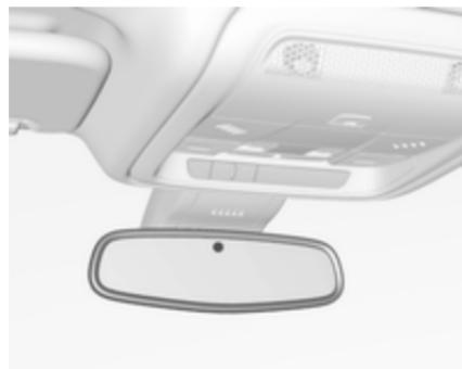
El deslumbramiento producido por los vehículos que nos siguen de noche se reduce automáticamente.
