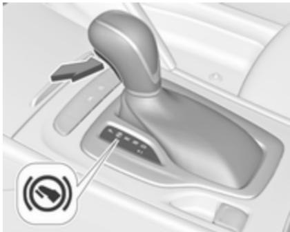
La palanca selectora está bloqueada en **P** y solo se puede mover con el encendido activado, el botón de liberación de la palanca selectora pulsado y el pedal de freno aplicado.
