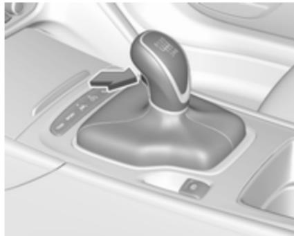
Para engranar la marcha atrás, pise el pedal de embrague, después, pulse el botón de desbloqueo de la palanca selectora y engrane la marcha.
