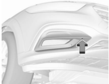
Afloje el tornillo con un destornillador Torx.
