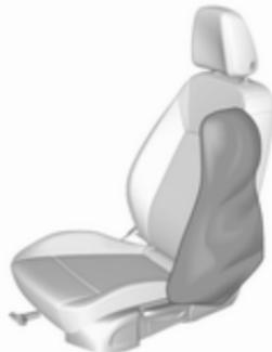
Los airbags inflados atenúan el impacto y reducen, por tanto, el riesgo de lesiones en la parte superior del cuerpo y la pelvis en el caso de que haya una colisión lateral fuerte.
