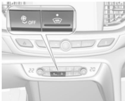
Si el vehículo está equipado con parabrisas térmico, el botón **ON/OFF** es sustituido por el botón .
