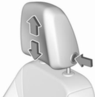
Pulse el botón de desbloqueo, ajuste la altura, enclave.
