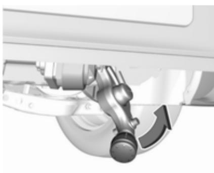
Con la palma de la mano, bascule la barra de rótula desbloqueada hacia la derecha hasta que quede enclavada debajo del piso. Asegúrese de volver a colocar el asa en su posición oculta inicial; en caso contrario, el aviso acústico no dejará de sonar.
