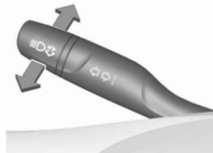
Pulse la palanca para cambiar de luz de cruce a luz de carretera.
