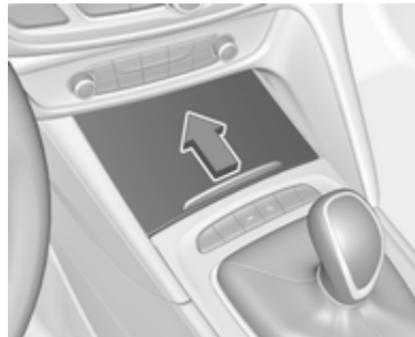
Hay un compartimento portaobjetos en la consola central. Presione la tapa por la parte delantera.
