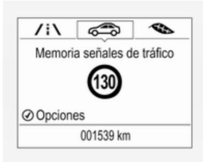
En la pantalla de nivel básico, cuando se muestre la página del asistente de señales de tráfico, pulse **SET/CLR** en la palanca de intermitente.
