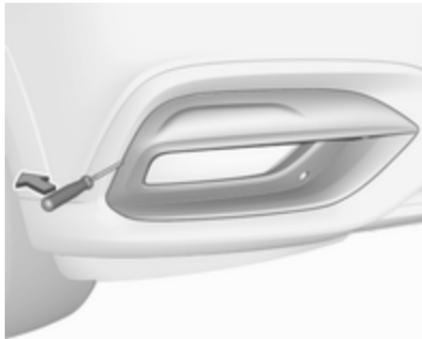
Envuelva un trapo alrededor de la punta del destornillador plano para evitar dañar la pintura. Haga palanca insertando el destornillador en el rebaje de la placa frontal y extrágala.
