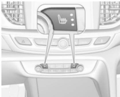
Para ajustar la potencia de calefacción deseada, pulse una o varias veces
