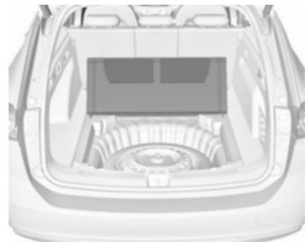
Coloque la cubierta plegada en vertical detrás de los respaldos de los asientos traseros.
