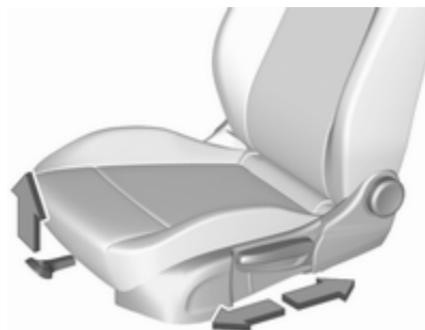
Tire del asidero, deslice el asiento, suelte el asidero. Intente mover el respaldo hacia delante y hacia atrás para asegurarse de que el asiento está bloqueado en su posición.
