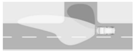
Al apagar, según el ángulo de dirección y la luz del intermitente, se activan LED particulares que iluminan la dirección de desplazamiento. Se activa hasta una velocidad máxima de 40 km/h.
