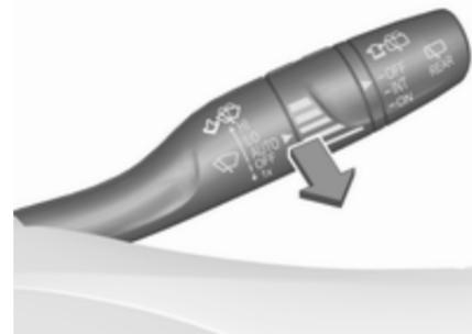
Tire de la palanca. Se pulveriza líquido de lavado sobre el parabrisas y el limpialuneta se realiza el barrido varias veces.
