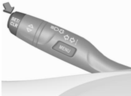
En la pantalla de nivel básico, pulse **SET/CLR** en la palanca de intermitentes para confirmar un mensaje.
