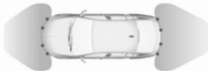
El sistema tiene cuatro sensores de aparcamiento por ultrasonidos en cada parachoques trasero y delantero.
