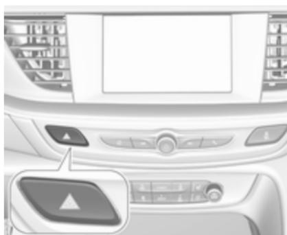
En caso de accidente con despliegue de los airbags, se activan automáticamente las luces de emergencia.
