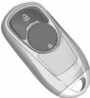
Pulse para desbloquear las puertas y el compartimento de carga. Abra las puertas tirando de la manilla correspondiente. Para abrir el portón trasero, presione el emblema de la marca y abra el portón trasero.
