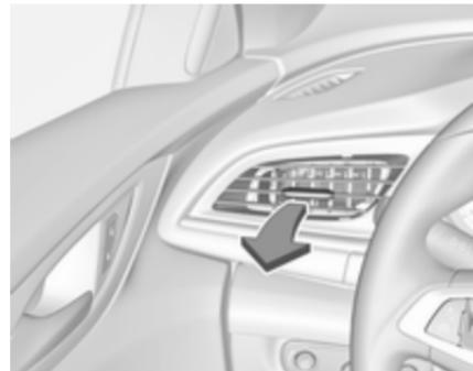
La imagen muestra las salidas de aire exteriores en el panel de instrumentos.
