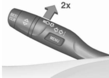
El asistente de luz de carretera se activa pulsando dos veces la palanca de intermitentes superando una velocidad de 40 km/h.
