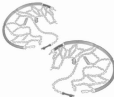
Sólo se pueden utilizar cadenas en las ruedas delanteras.
