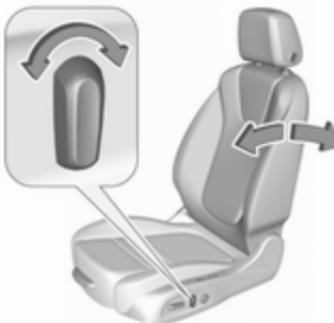
Incline el interruptor hacia delante / hacia atrás.
