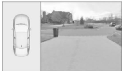
La pantalla de información está dividida en dos partes: en el lado izquierdo hay una vista desde la parte superior del vehículo, y en la parte derecha hay una vista de la parte delantera o de la parte trasera visualizada, conforme a la marcha puesta. Los sensores de estacionamiento completan la información sobre la vista.
