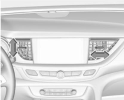
La imagen muestra las salidas de aire centrales en el panel de instrumentos.
