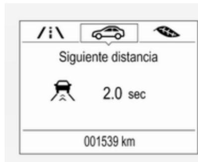
En la pantalla de nivel intermedio y superior, seleccione el menú **Info** con los botones del volante y pulse ▽ para seleccionar la siguiente indicación de distancia ▷ 119.
