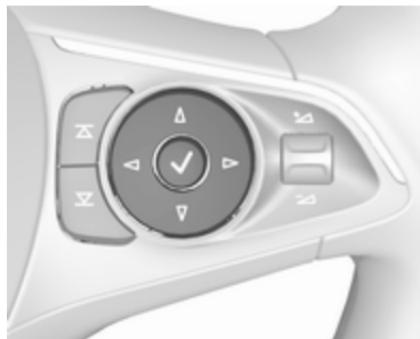
En la pantalla de nivel intermedio y nivel superior seleccione el menú **Infor.** pulsando en el volante. Pulse para seleccionar la página **Índice del est. útil del aceite**.
