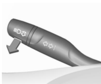
Para accionar las ráfagas, tire de la palanca.
