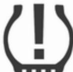
Si se detecta un problema de presión baja de los neumáticos, se indica mediante el testigo de control  $\text{!}$   $\diamond$  117.
