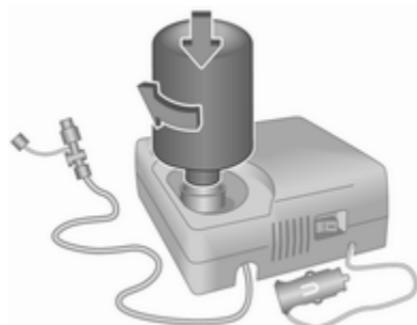
**Tipo 2:** retire el tapón de rosca del compresor y del bote de sellador. Enrosque el bote en el compresor sin retirar el papel de estaño.
