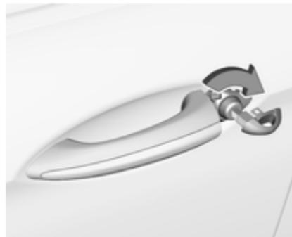
Pulse el pomo de bloqueo interior de todas las puertas excepto la puerta del conductor o pulse en el panel de la puerta del conductor. A continuación, cierre la puerta del conductor y bloquéela desde el exterior girando la llave en el cilindro de la cerradura. Es posible que la tapa del depósito de combustible y el portón trasero no estén bloqueados.
