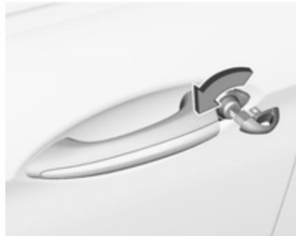
Desbloquee manualmente la puerta del conductor introduciendo y girando la hoja de la llave en el cilindro de la cerradura.
