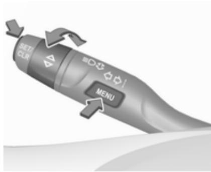
En la pantalla de nivel básico, seleccione en el menú **Infor.** ☰ a través de **MENU** y seleccione la página del asistente de señales de tráfico con la rueda de ajuste de la palanca de intermitente ⇨ 119.
