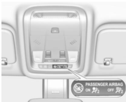
Si el testigo de control
