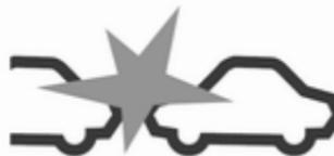
Cuando el tiempo hasta una posible colisión con un vehículo precedente es demasiado corto y la colisión es inminente, aparece el símbolo de alerta de colisión en el centro de información del conductor y el conductor recibe una notificación con una tira de LED rojos intermitentes o el símbolo emergente en la pantalla virtual que se proyecta en el parabrisas del campo de visión del conductor.
