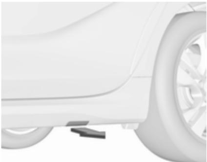
Algunas versiones tienen faldones laterales con tapas para los puntos de elevación del vehículo: primero debe retirar la tapa en el punto de elevación correspondiente.
