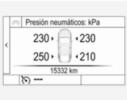
El estado del sistema y las diferencias de presión pequeñas se indican mediante un mensaje que indica el neumático correspondiente en el centro de información del conductor.
