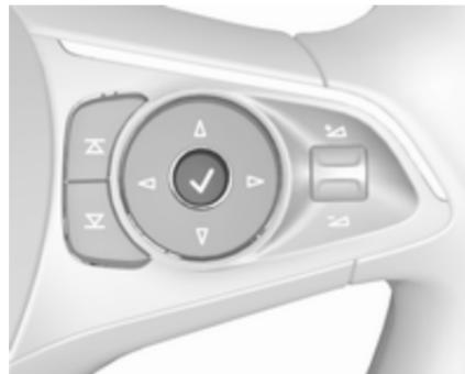
En la pantalla de nivel intermedio y nivel superior, pulse **✓** para confirmar el mensaje.
