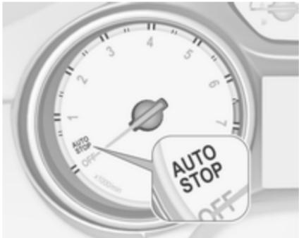
Si el vehículo circula a baja velocidad o está parado y se cumplen determinadas condiciones, se activa una función de parada automática (Auto-stop).
