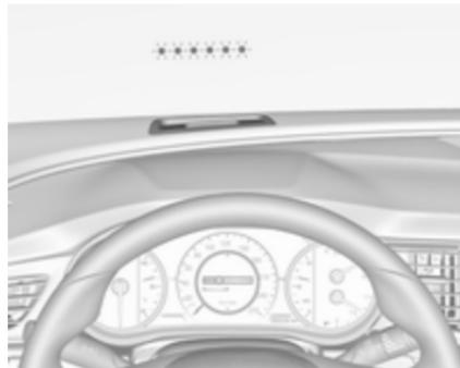
Al aproximarse a un peatón detectado demasiado rápido, se proyecta una alerta LED roja intermitente o el símbolo emergente ↗ en la pantalla virtual en el parabrisas en el campo de visión del conductor. Proporciona un aviso acústico. El sistema de frenos puede preparar para que el frenado del conductor se produzca de manera más rápida lo cual puede provocar una breve y suave desaceleración. Siga pisando el pedal del freno cuando sea necesario.
