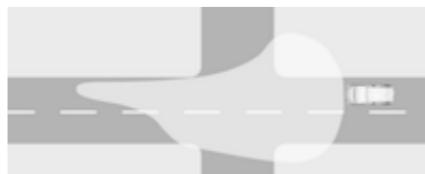
Se activa automáticamente a una velocidad de hasta aproximadamente 55 km/h y en situaciones con luz ambiente exterior. La luz es amplia y simétrica. Se ha diseñado un patrón de haz especial para evitar el reflejo a otros usuarios de la carretera.
