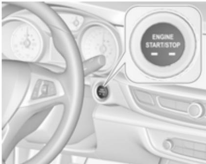
Cambio manual: accione el pedal del embrague y el freno.
