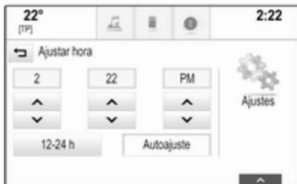
Seleccione **Autoajuste** en la parte inferior de la pantalla. Active **Activado - RDS** o **Desactivado - Manual**.
