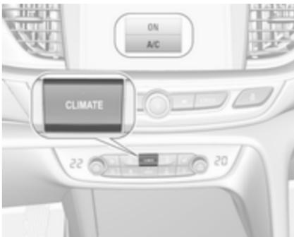
Pulse **Climate** para entrar en el menú y siga los botones táctiles para conectar A/C ON o desconectar A/C OFF el aire acondicionado.
