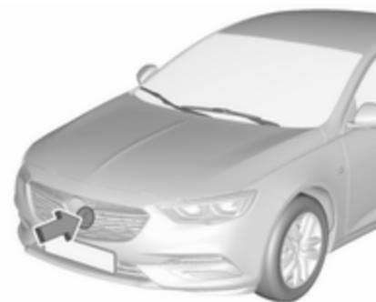
La unidad de radar está montada tras la rejilla del radiador, detrás o debajo del emblema de la marca.
