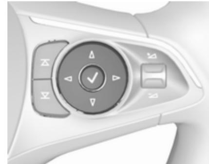
En la pantalla de nivel intermedio o superior, seleccione el menú **Infor.** con los botones derechos del volante y pulse ▲ o ▼ para seleccionar la página del asistente de señales de tráfico ⇨ 119.
