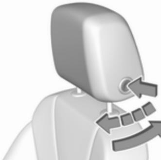
Pulse el botón de liberación, tire del cabezal del reposacabezas lentamente hacia delante. Se enclava en varias posiciones.
