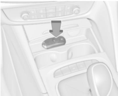
Abra la tapa de la consola central delante de la palanca de la caja de cambios. Coloque la llave electrónica con los botones hacia arriba en el bolsillo transmisor junto a la toma de corriente, como se indica en la imagen.
