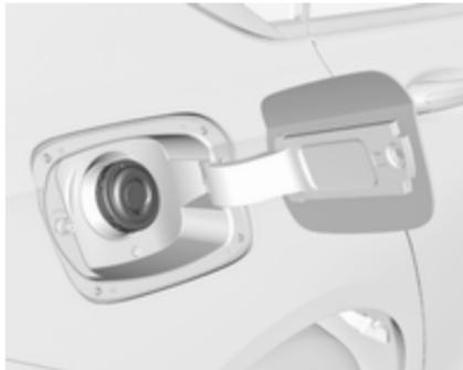
Coloque la boquilla en posición recta en la boca de llenado y presione ligeramente para insertarla.
