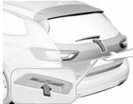
Después del desbloqueo, pulse el panel táctil situado debajo de la moldura y abra el portón trasero.
