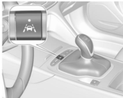
El asistente de mantenimiento de carril se activa pulsando . El LED del botón se ilumina para indicar que el sistema está conectado.
