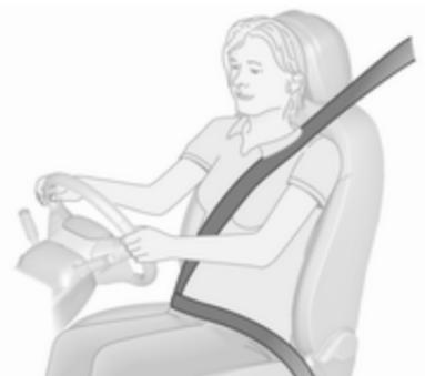
Al acelerar o frenar bruscamente el vehículo, los cinturones de seguridad se bloquean para sujetar a los ocupantes en la posición del asiento. De este modo, se reduce considerablemente el riesgo de que se produzcan lesiones.
