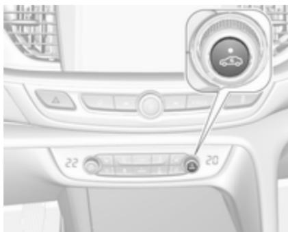
Pulse ⇧ para activar el modo de recirculación de aire. El LED del botón se ilumina para indicar su activación.
