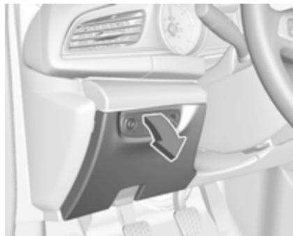
En los vehículos con volante a la izquierda, la caja de fusibles está detrás de una tapa en el tablero de instrumentos.
