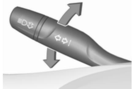
Cuando el vehículo está aparcado, se pueden activar las luces de estacionamiento de un lado:
