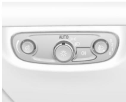
Cuando está conectada la función de control automático de las luces y el motor está en marcha, el sistema cambia entre luces de circulación diurna y conexión automática de los faros, dependiendo de las condicio-
