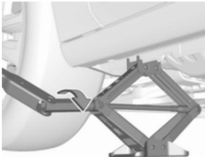
Acople la llave para ruedas y, con el gato correctamente alineado, gire la llave para ruedas hasta que la rueda se despegue del suelo.
