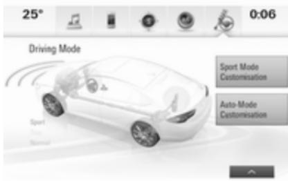
En la pantalla de información de 8" el menú de visualización de FlexRide se puede mostrar al tocar en la pantalla. En esta página se visualiza el modo de conducción la configuración activada.
