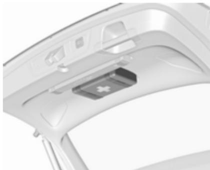
Guarde el botiquín con las correas de fijación en el panel interior del portón trasero.
