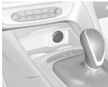
Hay una toma de corriente de 12 V situada en la consola central. Con el encendido desconectado, esta toma de corriente se desactiva.
