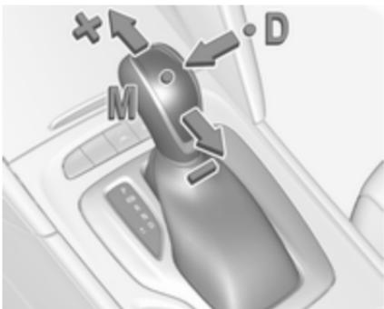
Saque la palanca selectora de la posición **D** hacia la izquierda en posición **M**.
