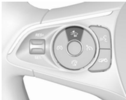
La primera vez que se pulsa el botón se muestra el ajuste actual en el centro de información del conductor. Si pulsa adicionalmente, se modificará este ajuste. El ajuste seleccionado permanecerá hasta que se modifique. La programación de la alerta variará en función de la velocidad del vehículo. A mayor velocidad del vehículo, a más distancia se producirá la alerta. Tenga en cuenta el tráfico y las condiciones meteorológicas cuando seleccione la programación de la alerta.
