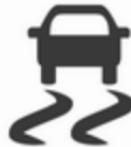
El TC está operativo cada vez que arranca el motor en cuanto se apaga el testigo de control .
