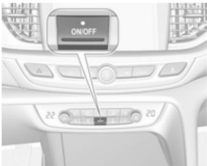
Se pueden desconectar la refrigeración, el ventilador y el modo automático pulsando **ON/OFF**. Cuando el sistema está desactivado, el LED del botón **ON/OFF** no se ilumina.
