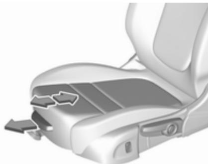
Tire de la palanca y deslice el apoyo para los muslos.
