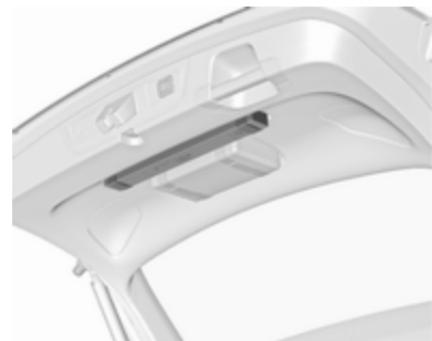
Guarde el triángulo de advertencia con las correas de fijación en el panel interior del portón trasero.
