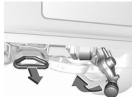
Tire del asa situada a la izquierda de la matrícula, debajo del panel del parachoques trasero, en un ángulo de aprox. 45° al suelo.
