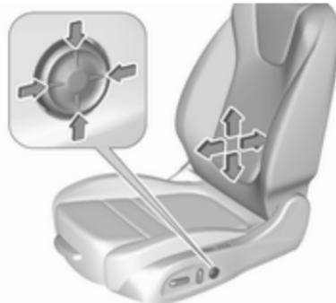
Ajuste el apoyo lumbar con el commutador de cuatro posiciones para adaptarlo a sus necesidades personales.
