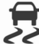
El ESC está operativo cada vez que arranca el motor en cuanto se apaga el testigo de control
