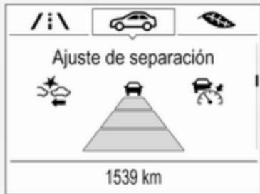
Si el control de velocidad adaptable está activo, esta página muestra el ajuste de sensibilidad de alerta en lugar del ajuste de la distancia de seguridad. ▷ 205.
