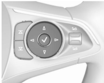
Pulse ▲ o ▼ para cambiar entre los menús principales o para volver de un submenú al siguiente nivel superior del menú.
