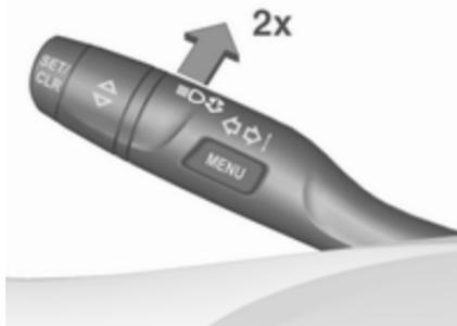
Active el asistente de luz de carretera pulsando dos veces la palanca de los intermitentes. La luz de carretera se enciende automáticamente a una velocidad superior a 50 km/h. La luz de carretera se apaga a una velocidad inferior a 35 km/h, pero el asistente de luz de carretera continúa activo.
