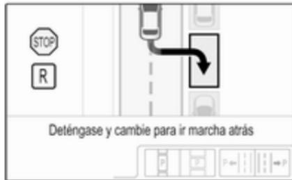
Al detectar un hueco, la pantalla de información en color ofrecerá información visual y una señal acústica. Si el conductor no detiene el vehículo después de la propuesta del hueco para aparcar, el sistema empieza a buscar otro hueco adecuado.
