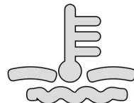
Si se enciende con el vehículo en movimiento, el motor estará sobrecalentado. Deténgase inmediatamente y apague el motor. Espere que el motor se enfrie, verifique el nivel del líquido refrigerante y si es necesario, complételo. Si el motor se sobrecalienta nuevamente, contacte un Distribuidor Ford.
