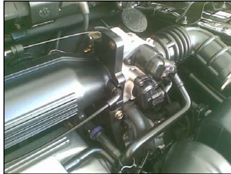
Estas dos fotografías indican la ubicación de la válvula IAC
