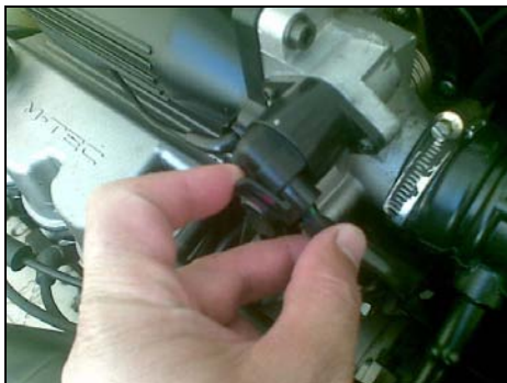
Con el dedo índice levanta ligeramente la pestaña de retención del conector
