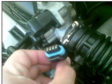
Con el dedo índice levanta ligeramente la pestaña de retención del conector
