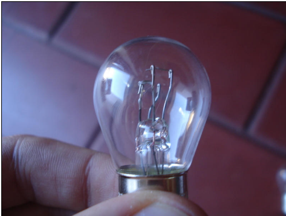
Bombilla tipo bayoneta, tiene dos potencias: 21W en alta y 5W en baja.
