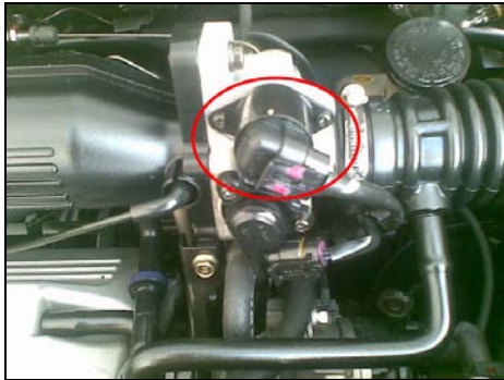
Estas dos fotografías indican la ubicación de la válvula IAC
