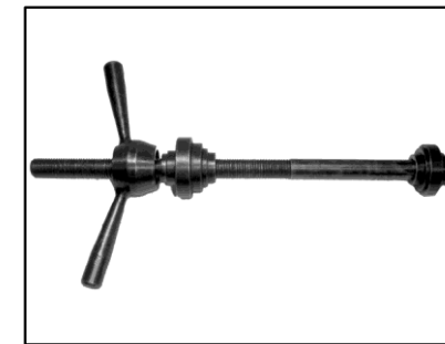
Instalador de baleros en el cuadro
