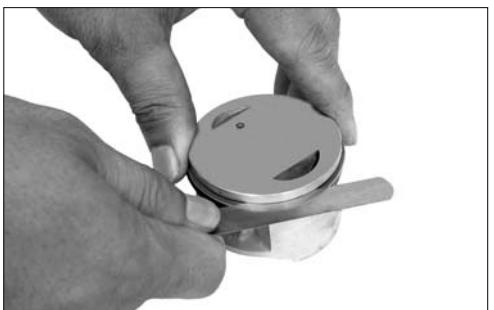
**TOOL** 09900-20803: medidor de espesor
