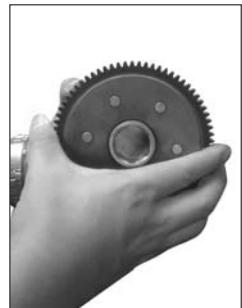
Si el amortiguador interno se desgasta, se genera juego entre el engranaje y la carcasa, lo que provoca un ruido anormal. Si el juego es demasiado grande, reemplace el conjunto del engranaje impulsado primario por uno nuevo.
