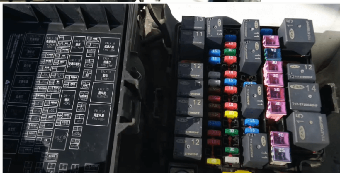
Foto del bloque y tapa de los fusibles y relés Chery Tiggo 4 debajo del capó
