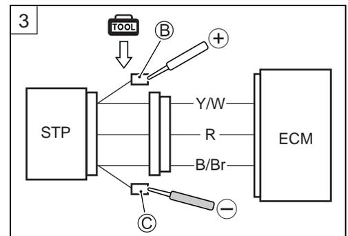
**DATA** Voltaje de salida del sensor STP
