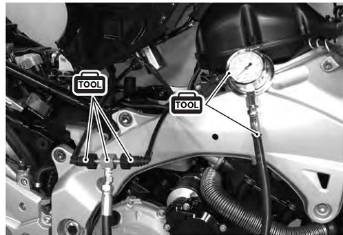
Ponga el interruptor de encendido en la posición ON y compruebe la presión del combustible.
