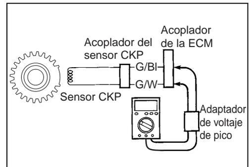
Si la tensión de pico es inferior al valor nominal, compruebe la tensión de pico en el cable principal del acoplador del sensor CKP.
