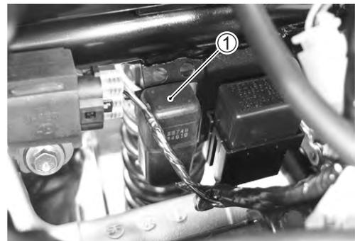
Primero compruebe el aislamiento entre las terminales A y B con el polímetro. Luego aplique 12 V a los terminales C y D, + a C y - a D y compruebe si hay continuidad entre A y B. Si se encuentra alguna anomalía, cámbielo por otro nuevo.
