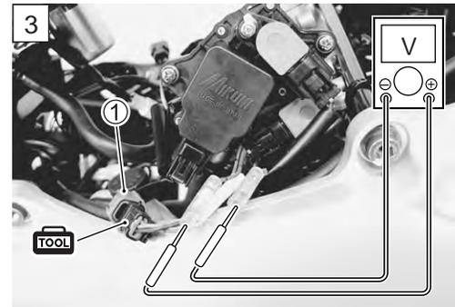
**DATA** Tensión de salida del sensor TP
