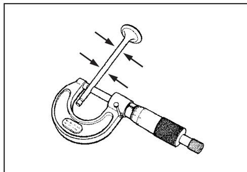
**MANTENIMIENTO DE GUÍAS DE VÁLVULAS**
