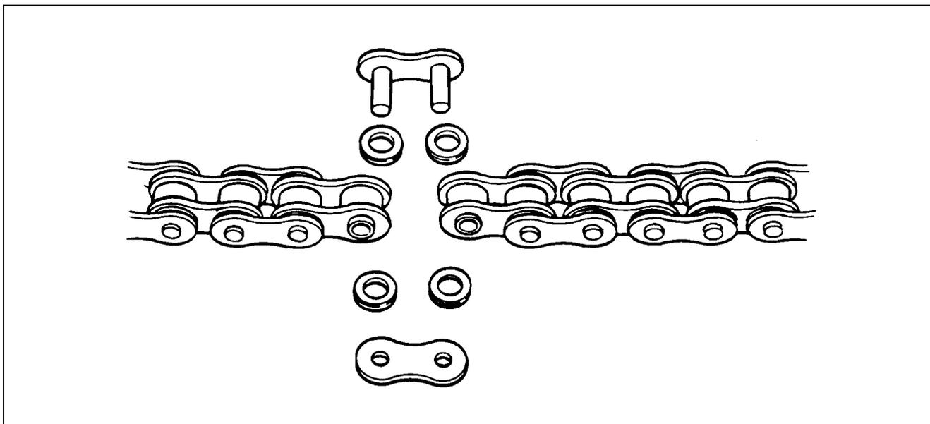
En los procedimientos que se describirán utilice la herramienta específica para cortar y volver a unir la cadena de transmisión.
