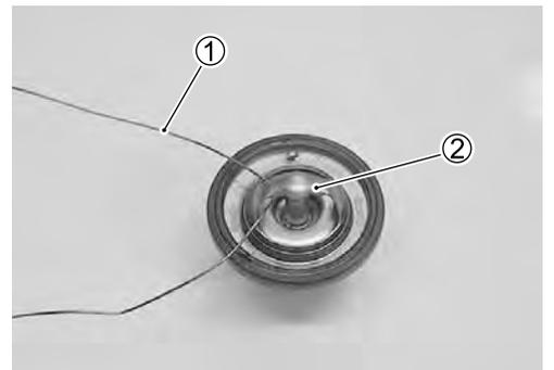
**DATA** Temperatura de apertura de la válvula del termostato
