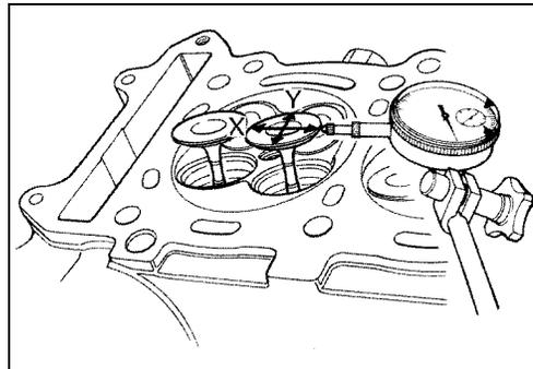
**DESGASTE DEL VÁSTAGO DE LA VÁLVULA**
