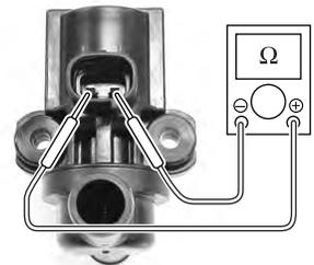
Si la resistencia no está dentro de la gama nominal, sustituya la válvula de solenoide de control PAIR por una nueva.
