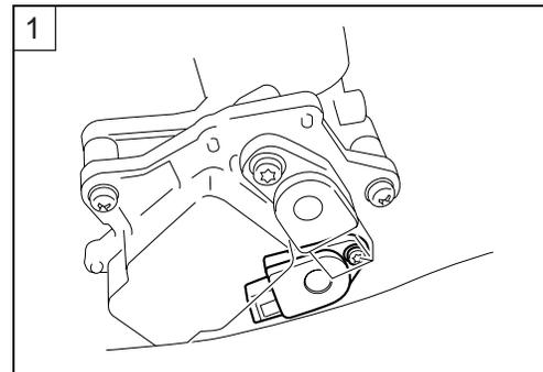
**DATA** Voltaje de entrada del sensor TP: 4,5 – 5,5 V
