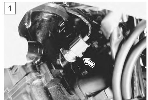
**DATA** Tensión del sensor ECT: 4,5 – 5,5 V
