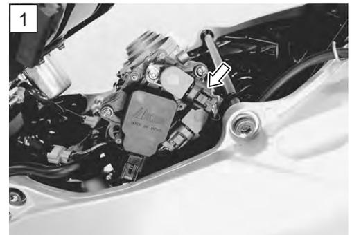
**DATA** Voltaje de entrada del sensor STP: 4,5 – 5,5 V
