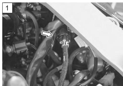
3) Desconecte el acoplador del sensor HO2 y mida la resistencia entre los terminales.
