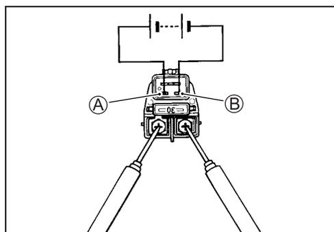
Mida la resistencia de la bobina del relé entre los terminales con el polímetro. Si la resistencia no está dentro de la gama especificada, cambie el relé de arranque por uno nuevo.
