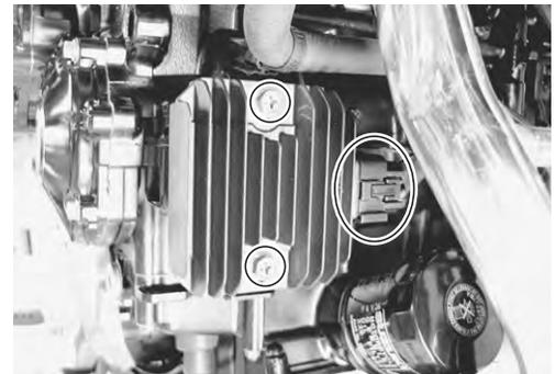
Mida la tensión entre los terminales con el polímetro de la forma que se indica en la tabla.
