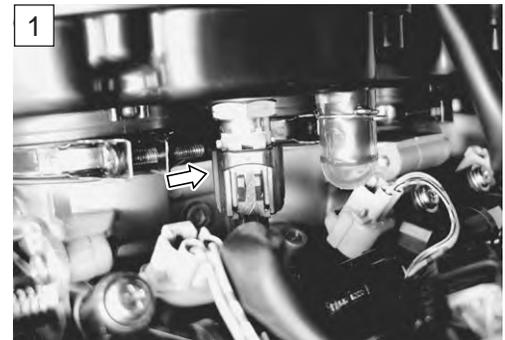
**DATA** Voltaje de entrada del sensor IAT: 4,5 – 5,5 V
