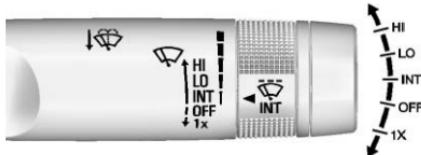
La palanca del limpiador/lavador del parabrisas está en el lado derecho de la columna de dirección. Estando la ignición en ACC/ACCESSORY (acc/accesorio) o en ON/RUN (encendido/funcionamiento), mueva la palanca de la escobilla del parabrisas para seleccionar la velocidad de movimiento de la escobilla.
