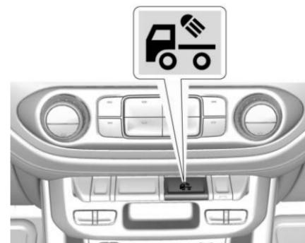
La luz de carga provee más luz en el área de carga del vehículo, si se requiere. También se encienden las luces dentro de la caja de la pick up, si están equipadas.
