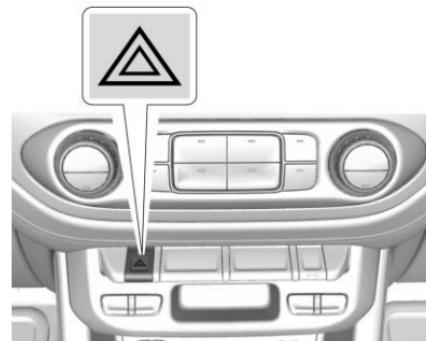
: Oprima para hacer que las luces direccionales delanteras y traseras destellen intermitentemente. Presione nuevamente para apagar las intermitentes.
