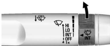
**INT** : Mueva la palanca hacia arriba hasta INT para pasadas intermitentes, luego gire la banda INT hacia arriba para pasadas más frecuentes, o hacia abajo para pasadas menos frecuentes.
