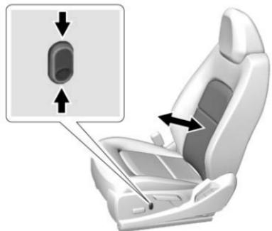
Si está equipado, oprima sin soltar la parte superior del control para incrementar el soporte lumbar.
