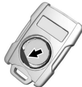
2. Presione la batería hacia abajo y deslícela hacia el bolsillo del transmisor en dirección al llavero. No utilice un objeto metálico.
