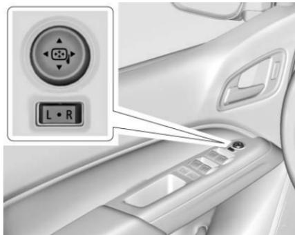
Si está equipado, ajuste los espejos eléctricos:
