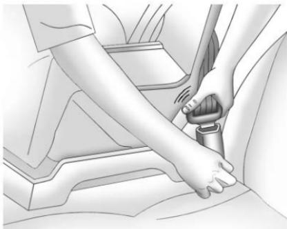
5. Empuje la placa de cerrojo dentro del broche hasta que escuche un sonido de clic. Coloque el botón de liberación sobre la hebilla, lejos del sistema de asiento de seguridad para niños, de tal forma que el cinturón de seguridad se desabroche rápidamente si es necesario.
