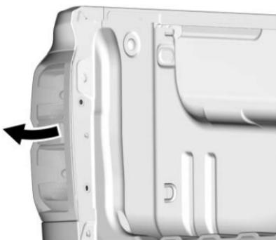
4. Jale el ensamble de la luz trasera de forma recta hacia atrás para retirarlo del vehículo.
