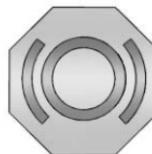
El tapón del depósito del líquido de frenos/embrague hidráulico tiene este símbolo. El depósito común del fluido de frenos se llena con líquido de frenos DOT 3, como se indica en el tapón del depósito. Vea en *Vista general del compartimiento del motor* ▷ 331 la ubicación del depósito.
