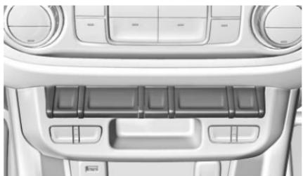
Encienda y apague el Modo de Remolque/Arrastre presionando el botón en la columna central. Cuando el Modo de Remolque/Arrastre está habilitado, se encenderá una luz en el grupo de instrumentos.
