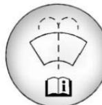
Abra el tapón que tiene el símbolo del lavaparabrisas. Agregue líquido para lavaparabrisas hasta llenar el tanque. Vea en *Vista general del compartimiento del motor* ▷ 331 la ubicación del depósito.
