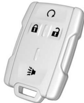
: Presione para abrir el seguro de la puerta del conductor. Presione de nuevo durante los tres segundos siguientes para abrir los seguros de las puertas restantes.
