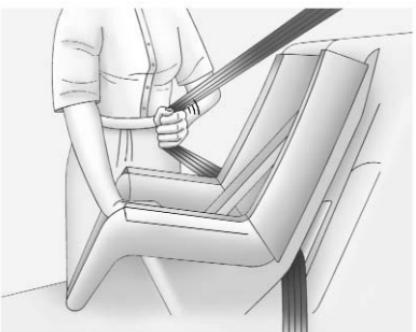
8. Jale el cinturón de hombro completamente fuera del retractor para ajustar el seguro. Cuando el seguro del retractor esté ajustado, el cinturón se puede apretar pero no se puede jalar fuera del retractor.
