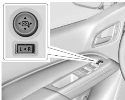
Si está equipado, ajuste los espejos eléctricos.
