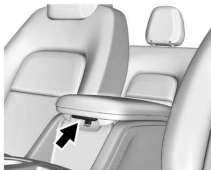
Hay almacenamiento debajo del descansabrazos en la consola central. Oprima el botón y levante. Dependiendo de las opciones, puede haber un puerto USB y/o conector auxiliar en el interior.
