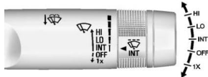
La palanca del limpiaparabrisas/lavador está en el lado derecho de la columna de dirección. Con la ignición en ACC/ACCESORY (acc/accesorio) u ON/RUN (encendido/funcionamiento), mueva la palanca del limpiaparabrisas para seleccionar la velocidad de la escobilla.
