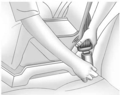
7. Empuje la placa de cerrojo dentro del broche hasta que escuche un sonido de clic. Coloque el botón de liberación sobre la hebilla, lejos del sistema de asiento de seguridad para niños, de tal forma que el cinturón de seguridad se desabroche rápidamente si es necesario.
