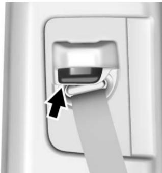
Presione hacia arriba el botón de liberación y mueva el ajustador de altura a la posición deseada.
