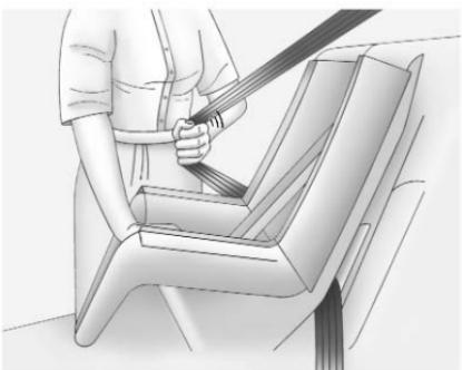
6. Jale el cinturón de hombro completamente fuera del retractor para ajustar el seguro. Cuando el seguro del retractor esté ajustado, el cinturón se puede apretar pero no se puede jalar fuera del retractor.
