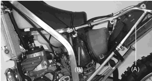
(A). Subchasis. (B). Caja de filtro.
