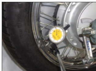
Desgaste axial de la rueda
