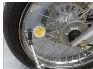
Desgaste radial de la rueda
