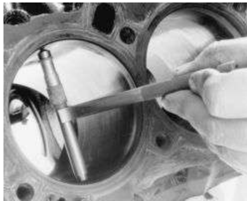
Higo. Higo. 13: Un medidor telescópico se puede usar para medir el diámetro del agujero de cilindro
