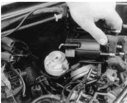
Fig. Fig. 6: Levante la tapa del distribuidor fuera y coloque a un lado
