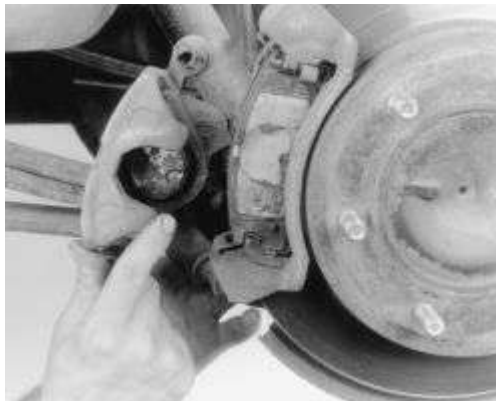
Higo. Higo. 2: Levante la pinza fuera de las almohadillas y el conjunto del rotor
