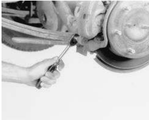
Higo. Higo. 1: Aflojar y retirar los tornillos de la pinza de retención
