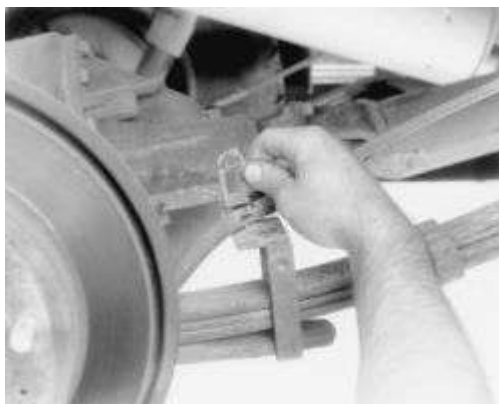
Higo. Higo. 9: Retire el soporte de retención para facilitar la extracción
