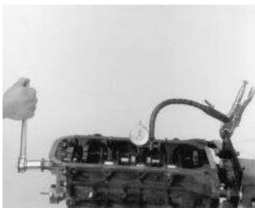
Higo. Higo. 9: Girar el cigüeñal lentamente con la mano mientras se comprueba el indicador Cigüeñal
