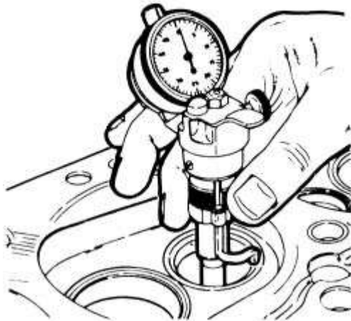
Higo. Higo. 14: Haga que la concentricidad del asiento de válvula controlados en un taller mecánico
