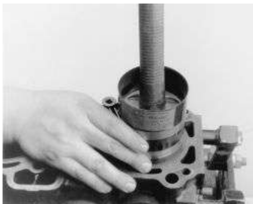
Higo. Higo. 40: Instalación del pistón en el bloque usando un compresor de anillo y el mango de un martillo
