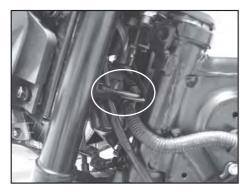
વાચરીગ હારનેસને ડાબી બાજુના રોડ જોઇનીગ કલેમ્પ માંથી પસાર કરો Route wiring harness beneath the rod joining lamp shade through LHS.
