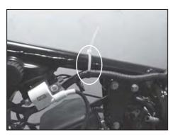
Clamp wiring harness near LHS H.T. coil using PVC clamp. વાચરીગ હારનેસને દાબી બાજુ HT Coil પાસે PVC કલેમ્પથી ફીટ કરો
