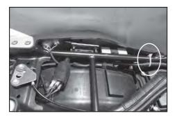
Clamp wiring harness near air filter using PVC clamp. વાચરીગને એર ફીલ્ટર નજીક PVC કલેમ્પ થી ફીટ કરો
