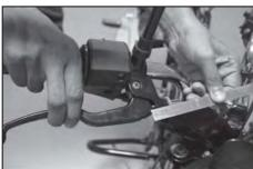
• Check front brake free play by using steel scale. સ્ટીલની માપ પટ્ટી વડે આગળની બ્રેકની ફિ પ્લે ચેક્કરો
