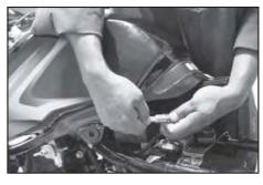
• Take out fuel tank by disconnecting the fuel gauge coupler. ફ્યુઅલ ગેજ કપલ૨ ડીસકનેકટ કરીને ટેન્ક બહા૨ કાઢો
