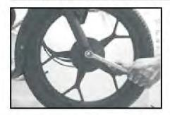
• Remove Front axle nut by 17mm ring spanner & take out front axle. આગળના વ્હત્ત્લની એક્સલને ૧७mmના રીગ સ્પેનર દ્વારા ખોલી એક્સલને બહાર કાઢો
