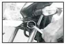
• Remove under bracket fork bolt by 13mm ring spanner ૧૩મમ૨ીગ સ્પેન૨ દ્વા૨ા અન્દ૨ બ્રેકેટના બોલ્ટને કોલો.
