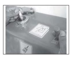
Clean the spark plug on spark plug cleaning machine. ২ঘার্ড দেশ হলীলীগ মগীল দেহ স্থার্ড দেশ মাহ হহী
