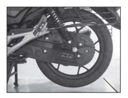
• Rotate the rear wheel for proper lubrication of entire chain. ચેનના બધાજ ભાગમાં સરખું લુબીકેશન કરવા પાછળનું વ્હીલ ફેરવો.
