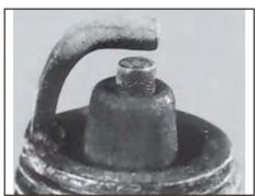
• Visually check spark plug electrode for color, erosion, crack & breakage. નજર વડે સ્પાર્ક પ્લગનો ઇલેટ્રાકોદનો કલર, ઇરોજન, તુટેલું કે તીરાડ ચેક કરો
