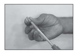
Clean the carburettor jets by low pressure compressed air. લો પ્રેશર કોમ્પ્રેસ્ડ હવા વડે
