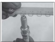
• Check and adjust spark plug gap by wire gauge. વાયર ગેજ વડે સ્પાર્ક પ્લગ ચેક કરો અને ગેપ એડજસ્ટ કરો
