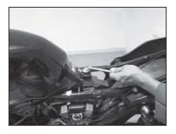
• Remove fuel tank mounting bolt using 10 mm spanner. 10 mm ના પાના વડે ફ્યુઅલ ટેન્ક માઉન્ટીગ બોલ્ટ ખોલો
