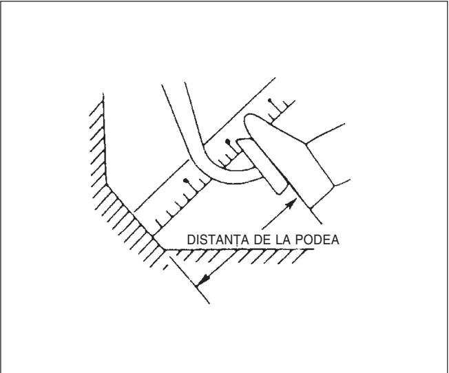
Fig. 8B – 5 Distanța între pedală și podea în momentul dinainte de cuplare a ambreiajului
