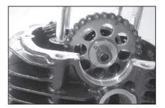
Using Special Tool : Sprocket Catcher - 3710 DH 36
