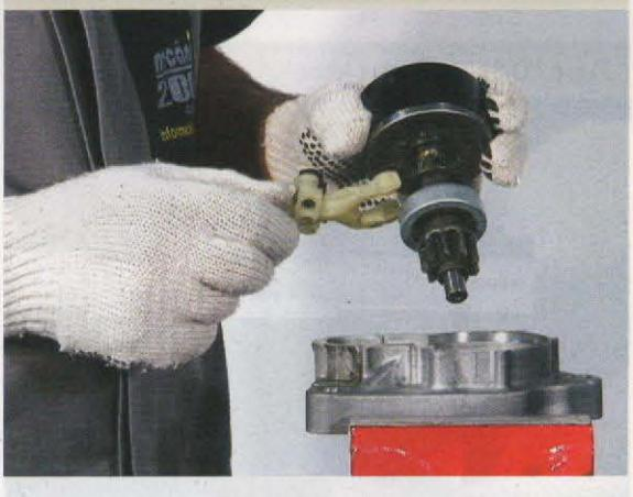
7-Lubrifique o êmbolo do solenóide com óleo, encaixe-o no garfo, e prenda suas porcas de fixação(Fig5);
