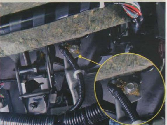
Aterramento T12: Fixado em baixo do painel na direção do motorista.
