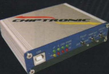
É um programador com tecnologia inovadora, que permite ler e gravar arquivos em centrais Diesel via diagnóstico (OBD), não havendo necessidade de dessoldar a Eprom; proporcionando assim, maior segurança, praticidade e rapidez. Pode ser ligado a uma porta USB de qualquer computador. O Kit acompanha equipamento, Softwares, cabo USB e cabo diagnóstico.
