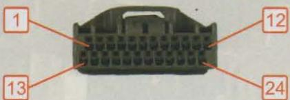
Conector do motor de controle da mistura de ar.
