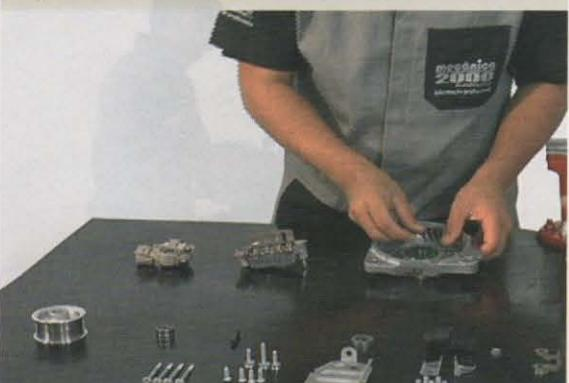
3-Instale o rolamento posterior no eixo do rotor, por meio de uma prensa (Fig.3);
