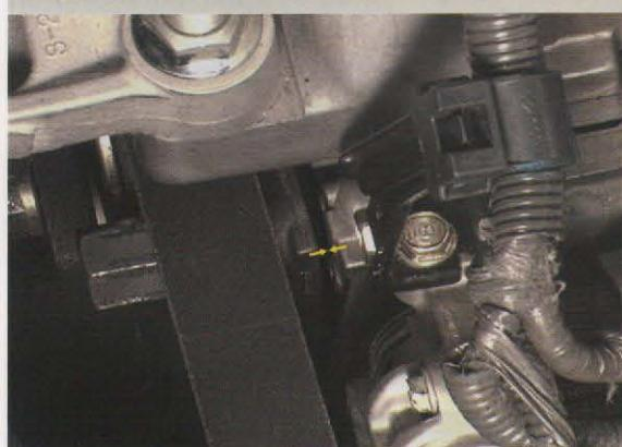
**⚠** Se estiver fora da faixa, substitua a correia. Por ser hidráulico, o autotensionador deve ser girado lentamente.
