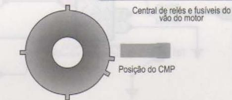
Placa de pulso instalada na árvore de comando de válvulas
