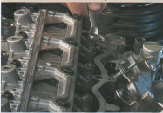
3-Insira a lâmina de calibragem de 0,20 mm entre o parafuso de regulagem e a válvula (Fig.3);
