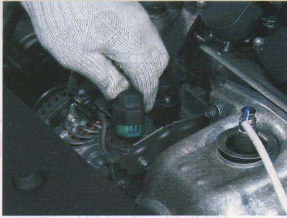
10-Solte os parafusos de fixação, e os conectores do chicote elétrico às bobinas (Fig.5) ;
