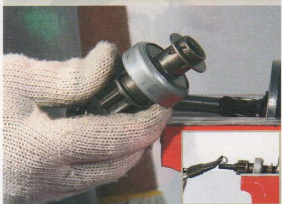
13-Remova, utilizando um alicate expensor, a trava que fixa o eixo helicoidal à carcaça da caixa de redução (Fig.9);
