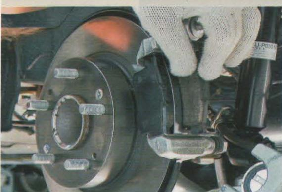
8-Instale o flange sobre as pastilhas, aperte seus parafusos e aplique torque de 23 Nm (Fig.6);
