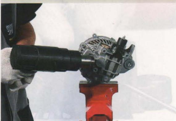
4-Utilizando duas chaves de fenda, separe os dois mancais, observando o cuidado de não danificar o estator (Fig.4);
