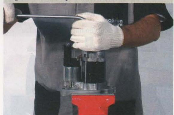
14-Confirme a eficiência do motor de partida, testando-o na bancada de testes.
