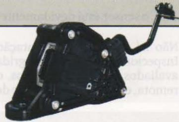
motor. O módulo de comando utiliza essa informação, para posicionar a borboleta motorizada no ângulo correto, que represente a solicitação desejada, produzindo a alteração de torque do motor, requerida pelo condutor.
