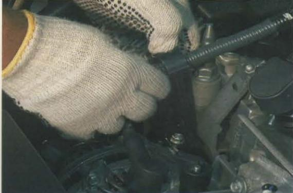
5-Retire os parafusos de fixação superior e inferior, utilizando catraca com soquete de 12mm, remova o alternador, e leve-o para a bancada; (Fig.5).
