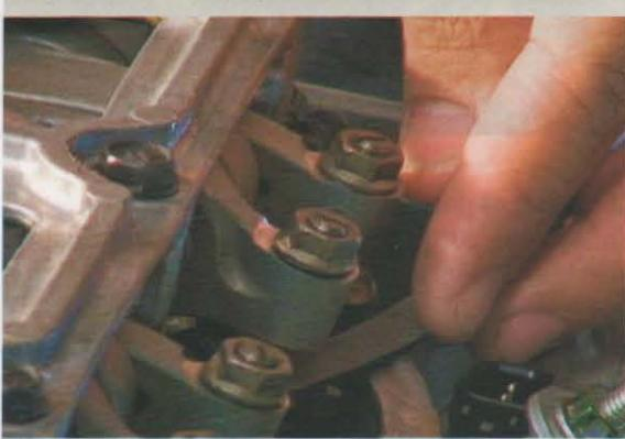
4-Utilizando uma chave de fenda, aperte ou desaperte o parafuso de regulagem, até obter a folga desejada. A lâmina deve deslizar suavemente entre o parafuso e a válvula (Fig.4);
