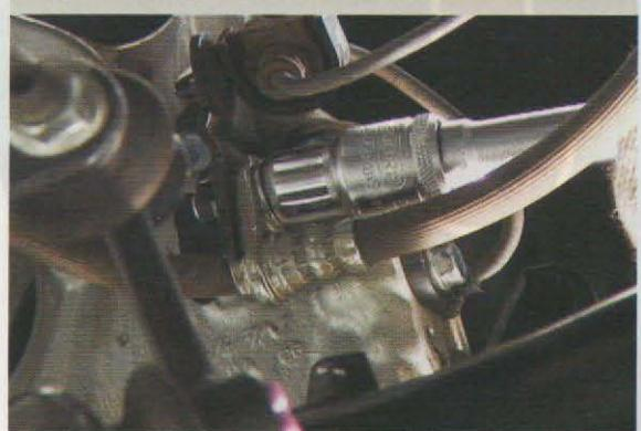
10-Abaixe o veículo, e aplique torque de 108 Nm aos parafusos de forma cruzada (Fig.8);
