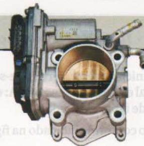
posição mínima de abertura. Dois potenciômetros, instalados no ETC, informam ao módulo a posição instantânea da borboleta, permitindo o controle em malha fechada com precisão de posicionamento.
