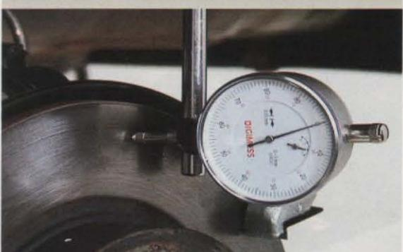
11-Gire o disco lentamente, confira o empreamento, se for superior a 0,10 mm substitua o disco;
