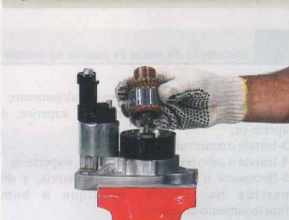
10-Instale a carcaça e ligue o cabo da bobina de campo ao solenóide (Fig.8);
