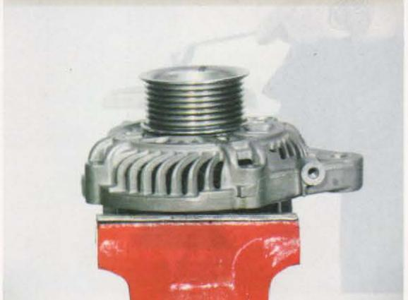
7-Retire a porca de fixação, utilizando um cabo de força com soquete de 24 mm, para remoção da polia (Fig.7);
