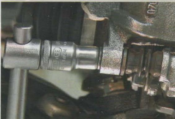
7-Retire também o parafuso de fixação do tubo flexível do freio;
