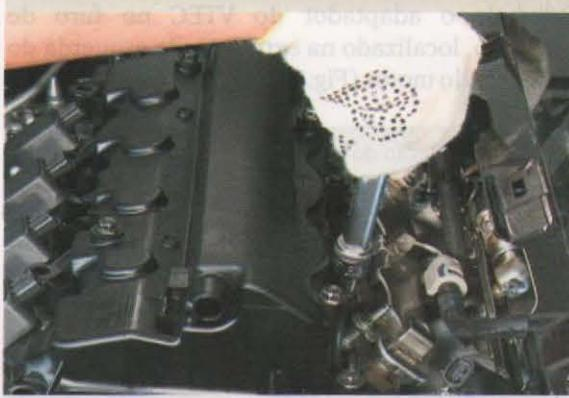
15-E finalmente retire a tampa das válvulas (Fig.10);
