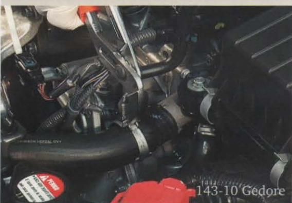
2-Encaixe os adaptadores Truck's e ajuste as abraçadeiras, usando também chave tipo canhão de 8 mm (Fig.2);
