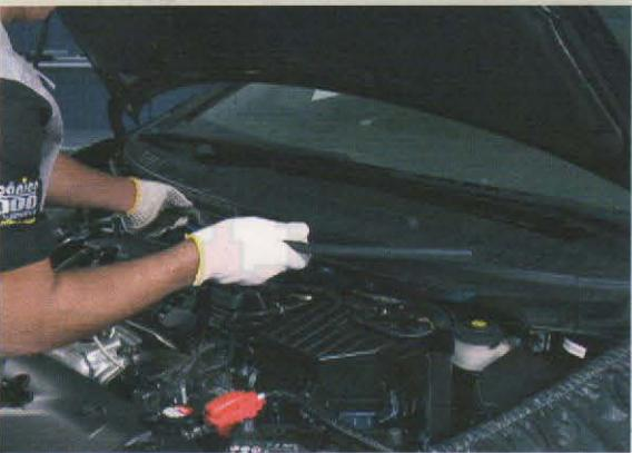
4-Solte todas as presilhas de fixação da tampa plástica de proteção dos amortecedores e remova a tampa;
