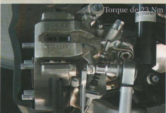
9-Instale o parafuso de fixação do tubo flexível do freio e instale a roda (Fig.7);
