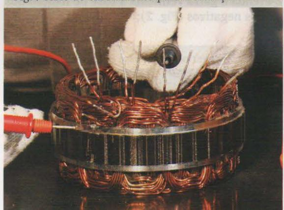
5-Encoste a outra ponta de prova em todos os terminais de bobinas (Fig.5);
