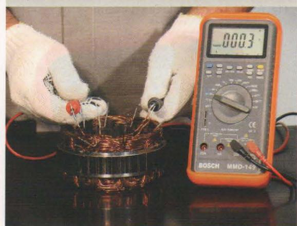
**✓ A resistência, entre os terminais com contato, deve ser próximo de zero Ohm.**
