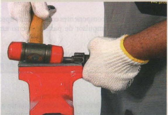
6-Encaixe o garfo nas guias do impulsor de partida, e instale todo o conjunto no mancal posterior (Fig.4);
