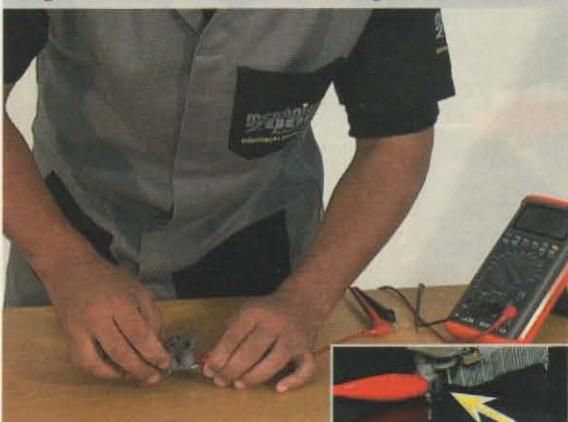
3- Encoste a ponta de prova preta às partes isoladas dos diodos negativos(Fig.3);
