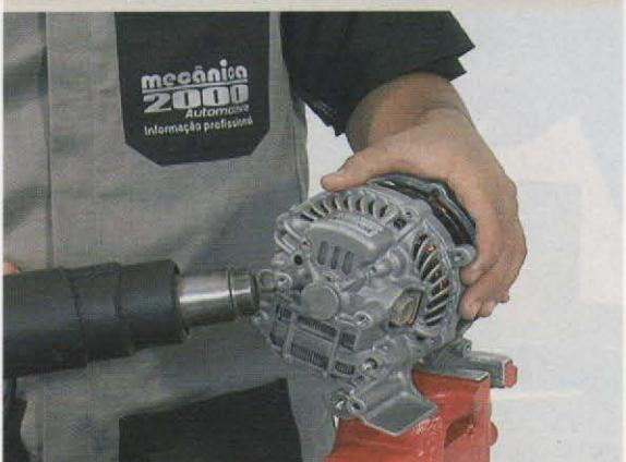
9-Feche o alternador, unindo os dois mancais e aperte os parafusos de fixação (Fig.9);
