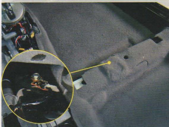
**Aterramento T17:** Fixado próximo da lateral traseira esquerda.
