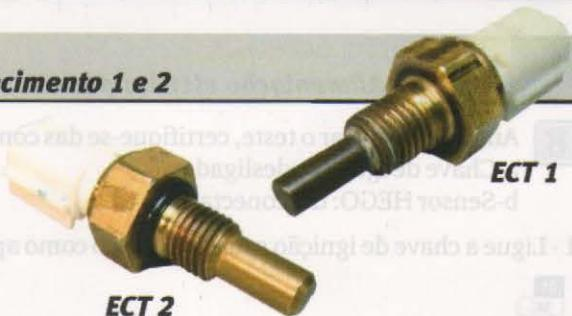
de arrefecimento. O sensor do radiador é utilizado para o controle do acionamento do eletroventilador, e o sensor do motor é utilizado para controle da razão ar/combustível nos períodos de aquecimento e operação normal. Abaixo, encontram-se os diagramas elétricos dos sensores.
