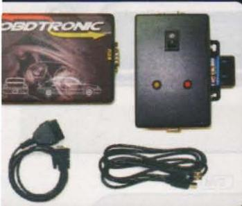
O OBDTronic é um leitor e programador de centrais micro-híbridas que permite a comunicação com centrais via diagnóstico, ou seja, sem a necessidade de desmontar a central. O equipamento pode ser utilizado tanto para conversão e otimização como também em sistemas imobilizadores.
