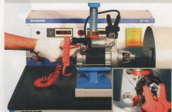
Se a tensão se mantém acima de 11,5V, indica que o motor de partida está em perfeitas condições de funcionamento
