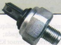
inicia uma rotina de atraso do ponto de ignição. Essa alteração do ponto de ignição permanecerá até que cesse a detonação, quando então o ponto retorna ao mapa básico. Abaixo está apresentado o diagrama elétrico com o borne do módulo que recebe o sinal de tensão.
