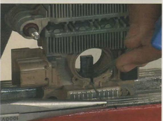
6-Fixe as bobinas do estator ao conjunto retificador, com um alicate de bico, e solde-as em seguida (Fig.6);
