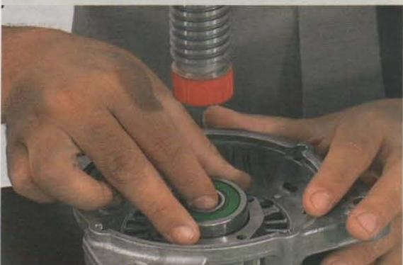
2-Fixe a placa retentora do rolamento com seus parafusos (Fig.2);
