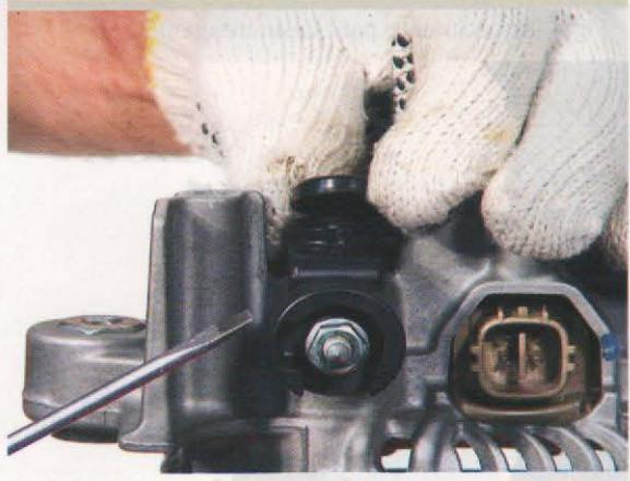
13-Utilizando uma chave biela de 10mm, remova o isolador do borne B+ (Fig.13);
