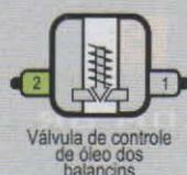
Sem alimentação elétrica, a válvula deve permanecer fechada, impedindo o fluxo de óleo para os balancins auxiliares.
