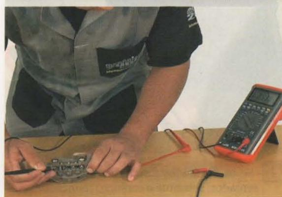
4- O multímetro indica diodo conduzindo (Fig 4);
