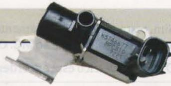
permite a passagem do vapor de combustível, proveniente do tanque para o coletor de admissão, para ser incorporado à mistura ar/combustível. Quando fechada, os vapores são direcionados para o cânister, onde são absorvidos pelo filtro de carvão ativado. Abaixo encontra-se o diagrama elétrico de acionamento da CANP.
