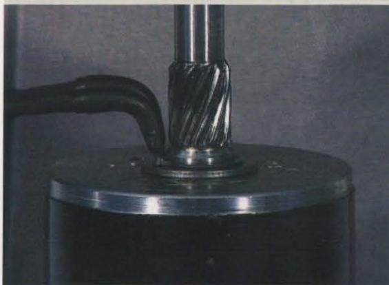
14-Remova a engrenagem plástica, observando a referência na carcaça, e verifique o estado de conservação dos dentes (Fig.10);
