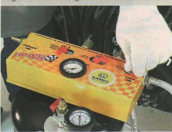
8-Engate, à entrada do equipamento, uma mangueira de água conectada a uma torneira ;
