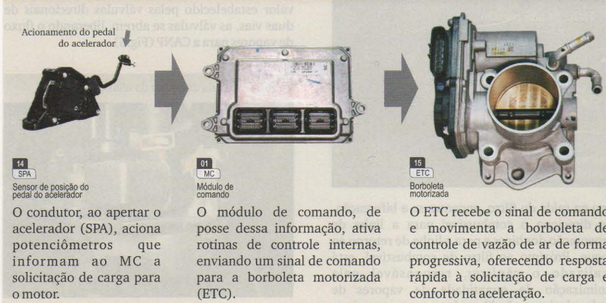
O condutor, ao apertar o acelerador (SPA), aciona potenciômetros que informam ao MC a solicitação de carga para o motor.
