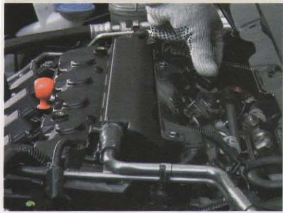
12-Solte os parafusos de fixação do chicote, desloque-o e desconecte o sensor ETC (Fig.7);
