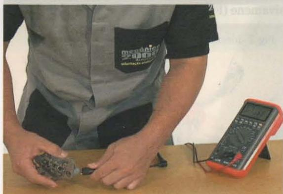
6-Encoste a ponta de prova vermelha às partes isoladas dos diodos negativos; o multímetro mostra que não há condução do diodo (Fig.6);
