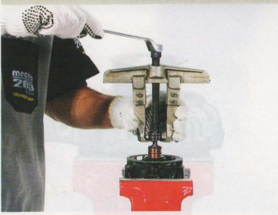
10-Remova a placa de retenção do rolamento do mancal anterior, e utilizando um cilindro maciço e martelo, remova o seu rolamento (Fig.10);
