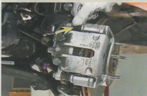
6-Retire o parafuso inferior de fixação do flange, utilizando cabo de força e soquete de 12 mm (Fig.3);
