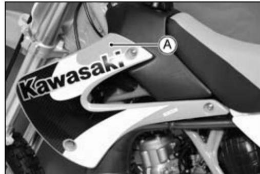
• Retire la banda del tanque de combustible [A] y el soporte del tanque de combustible.
