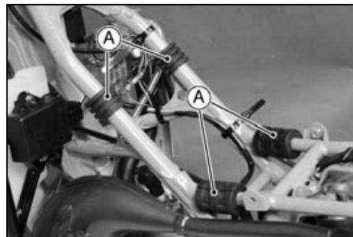
• Inserte el extremo de salida de la manguera de respiración del tanque de combustible en el número orificio de la placa de fibra de vidrio (consulte la sección Enrutamiento de cables, alambres y mangueras en el capítulo Información general).
