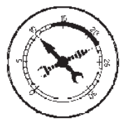
MUELLES DE VALVULA DESGASTADOS (MAS PRONUNCIADO AL AUMENTAR LA VELOCIDAD DEL MOTOR)
