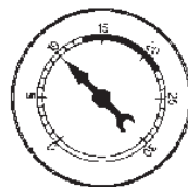
REGULACION DE VALVULAS ATRASADA, PERDIDA DE VACIO EN RALENTI
