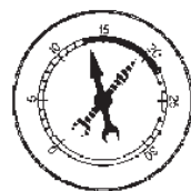
GUIAS DE VALVULAS DESGASTADAS (PERMANECE ESTABLE A MEDIDA QUE AUMENTA LA VELOCIDAD DEL MOTOR)
