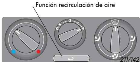
La chapaleta de aire fresco/recirculante se acciona por medio de un servomotor. Todas las demás chapaletas se accionan a través de cables Bowden. En la función de descongelación se desactiva mecánicamente la función de recirculación de aire.
