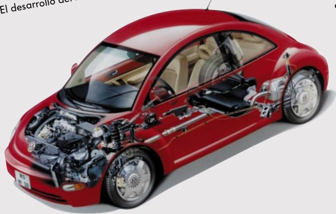
La plataforma del Consorcio no daba cabida a un motor trasero. El motor y el grupo motopropulsor van alojados delante.
