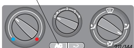
En el caso del aire acondicionado manual, el conductor controla el microclima en el habitáculo. La chapaleta de aire fresco/recirculante se acciona por medio de un motor eléctrico. Todas las demás chapaletas se accionan por medio de cables Bowden.
