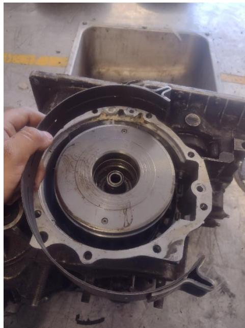
Con esto aflojaremos la banda para que todo el conjunto de embragues, planetarios, solares pueda salir
