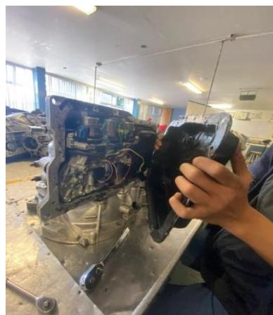
Retiramos 14 tornillos de 10mm para poder extraer el cuerpo de válvulas primario.
