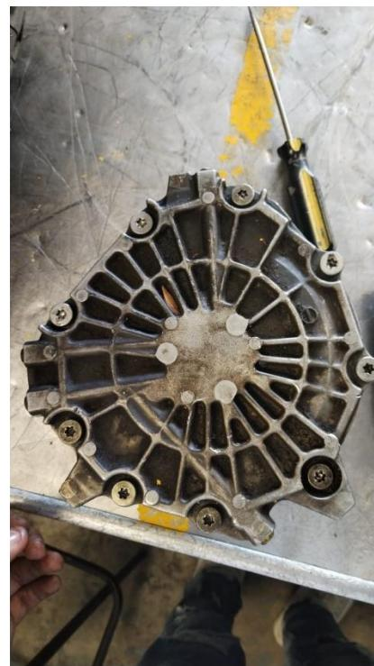
Removeremos el tornillo que sujeta la banda de freno medida 14mm
