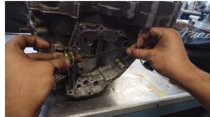
Desconectamos el cuerpo de válvulas secundario para después, retirar 5 tornillos de 10mm y sacar el cuerpo de válvulas secundario junto con su conector.
