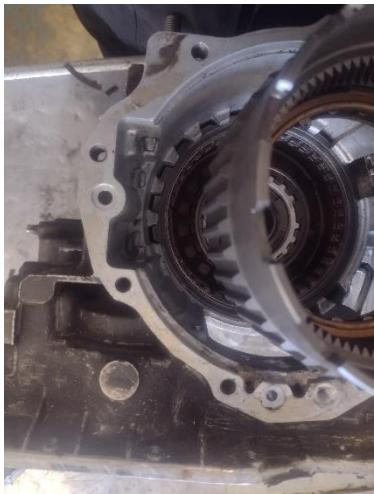
Retiramos la cama de resortes de retorno después con un desarmador retiramos un seguro de retención para las pastas para los discos de fricción. Y así sacaremos la pasta de los discos de embrague
