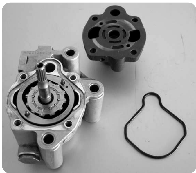
Interior de la bomba de Rotor con paletas
