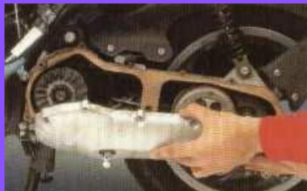
Ya tenéis todo a mano. Ahora debéis quitar la tuerca que fija el variador al eje del cigüeñal. Como éste gira, hay que inmovilizarlo con una herramienta especial ( llamada estrangulador ), que si no disponéis de ella, podéis reemplazar con un destornillador, mordaza...
