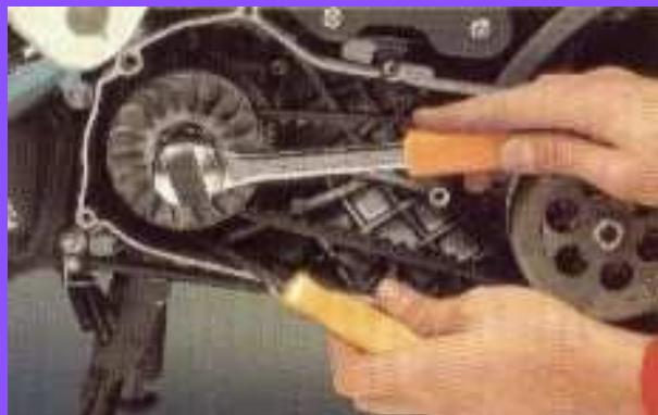
Posteriormente, retirad la tuerca y extraed la arandela que fija el ventilador, tras lo cual podéis extraer esta pieza. Dejaréis al descubierto la correa y la otra cara del variador. Seguidamente retirad la correa del eje, prestando atención también a una pequeña arandela que hay intercalada entre las dos semipoleas.
