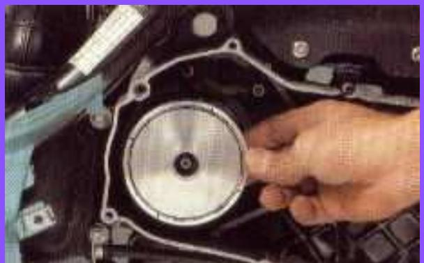
Posteriormente poner la correa en el eje, la arandela pequeña de separación, y finalizar el proceso montando el plato ventilador, la arandela grande exterior y la tuerca de fijación, que debéis apretar con decisión y fijando el el plato ventilador.
