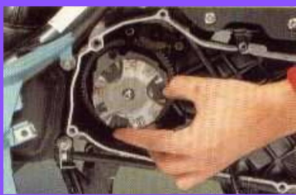
En el montaje engrasad ligeramente los rodillos, y situadlos en la posición correcta en el cuerpo del variador.
