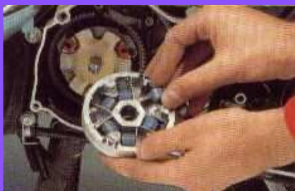
Al introducir el variador en el eje recordad mantener apretadas las dos partes para evitar que se salgan los rodillos. A continuación, introducir el bulón en el eje, presionando hasta que penetre en el cuerpo circular.
