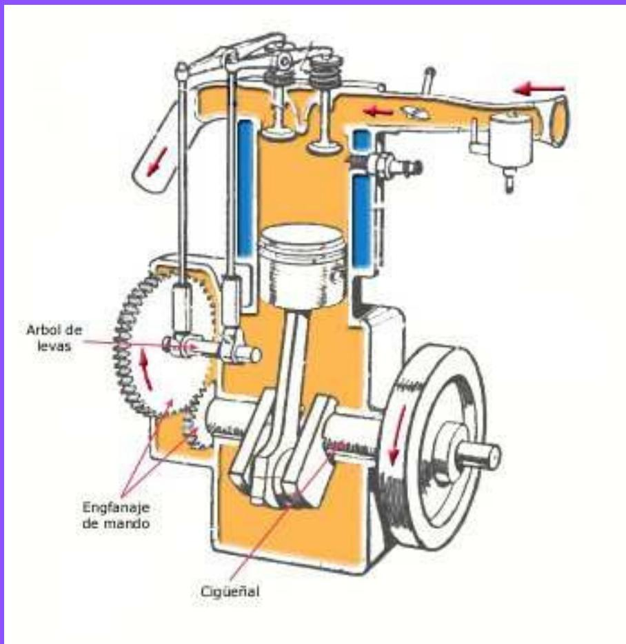
Al girar el cigüeñal, hace girar al eje de levas a la mitad de vueltas. Esto se logra al engranar un piñón con el doble de dientes, y esto se entenderá al recordar que por cada dos vueltas del cigüeñal, sólo se efectúa un ciclo completo, esto es, que en cada cilindro se produce una sola admisión y un solo escape (Fig 2).
