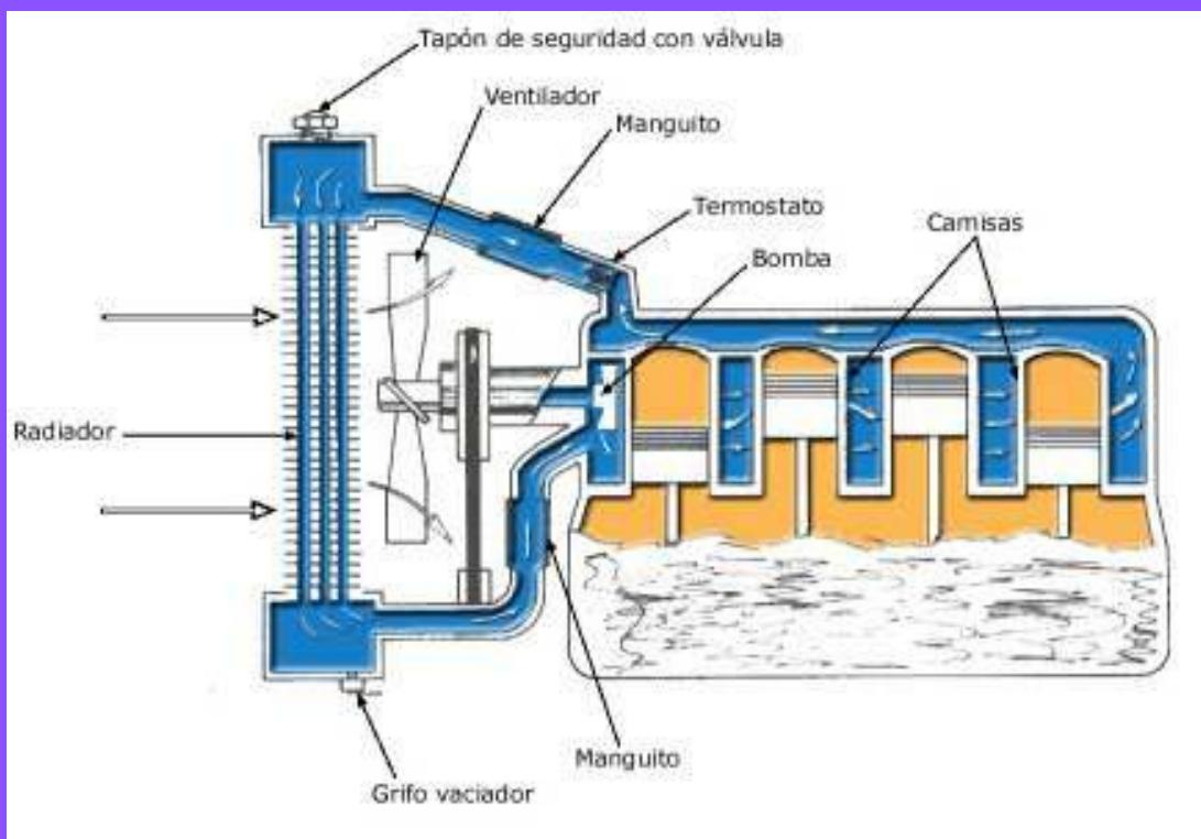
Una polea accionada accionada por el cigüeñal hace funcionar el ventilador que lleva a pasar el aire por el radiador.
