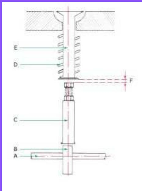
En un motor caliente, si se observa que las válvulas no cierran herméticamente, será debido, generalmente, a que los taqués están mal reglados.
