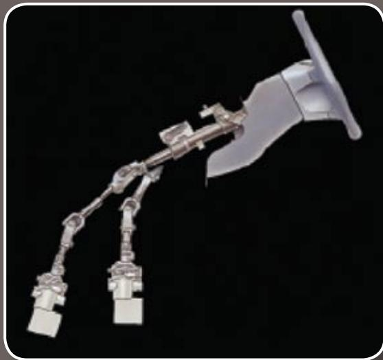
La columna de la dirección posee un mecanismo de absorción de energía. Cuando un impacto es transmitido hacia la columna de la dirección, ésta se deforma progresivamente para evitar daños físicos al motorista, sin invadir el interior del vehículo.
