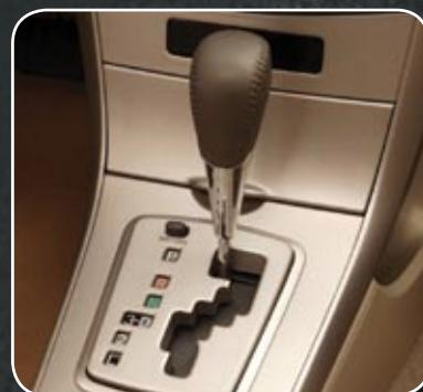
La transmisión automática disponible en el Nuevo Corolla pasa a utilizar la tecnología Súper ECT, que trabajando en conjunto con el ETCS-i, y analiza las condiciones de uso del vehículo (ladera, subida, tránsito y otros...) y, en función de éstas, selecciona y mantiene la marcha más adecuada para la condición de palanca en la posición D), evitando cambios innecesarios, optimizando el desempeño y también reduciendo el nivel de emisión de contaminantes.
