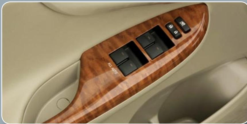
El Nuevo Corolla pasa a ofrecer accionamiento de un toque para subir y bajar las ventanas (delanteras y traseras en los modelos procedentes de Brasil, disponible para los modelos procedentes de Japón para la ventana del conductor) con anti-aplastamiento, de esta forma se puede disfrutar de este parte práctica con total seguridad.
