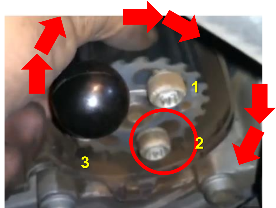
Ranura de la rueda dentada GIRA en la bomba de inyección
