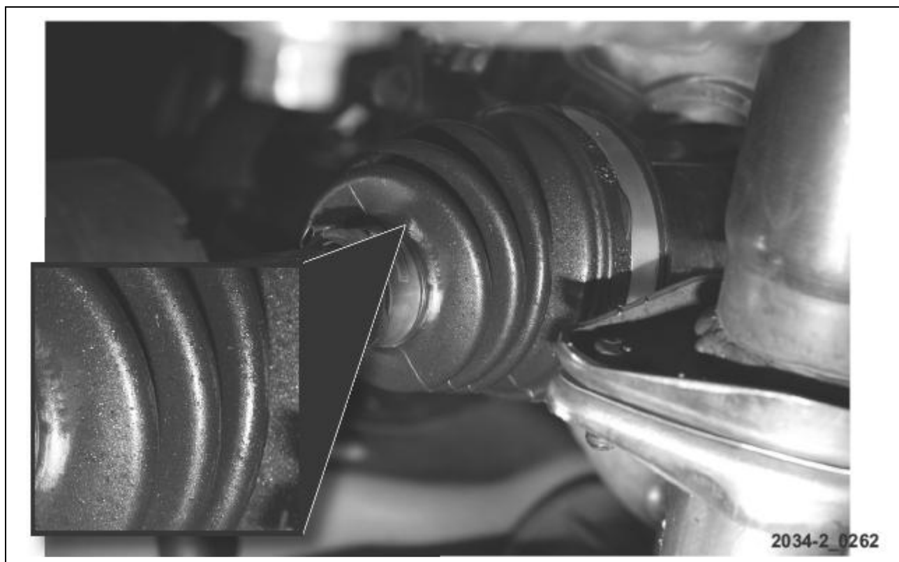
Figura 197 Escurrecimiento normal de la bota CV
