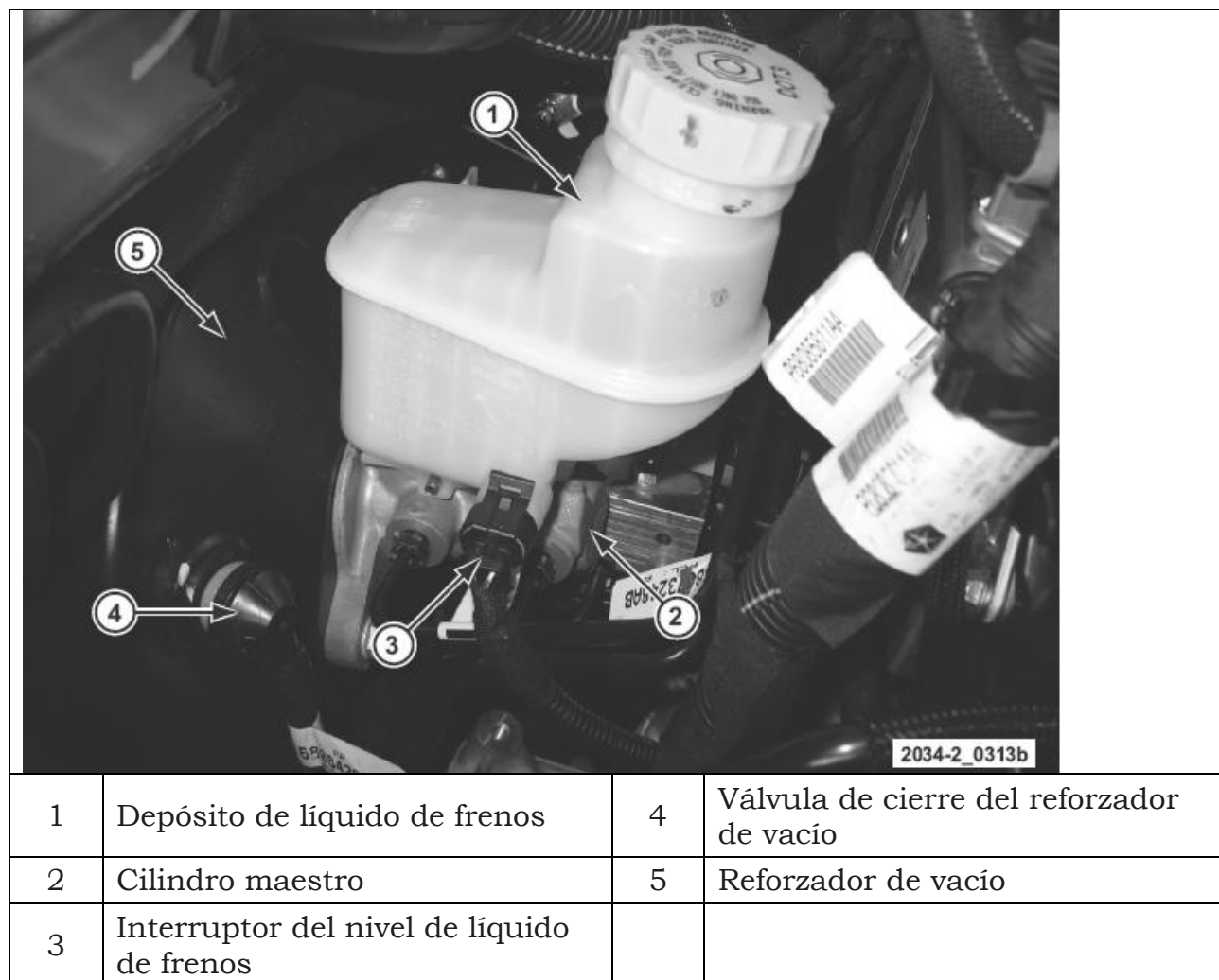
Figura 238 Reforzador de vacío, cilindro maestro y depósito de líquido de frenos
