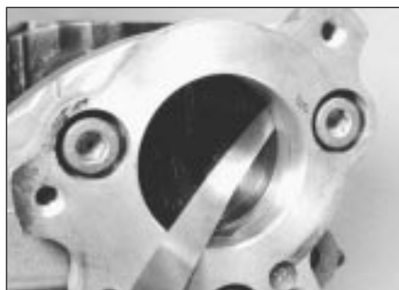
10.12 Checking camshaft endfloat
