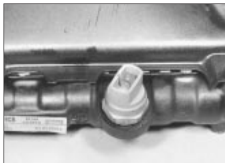
7.3 Cooling fan thermo-switch
