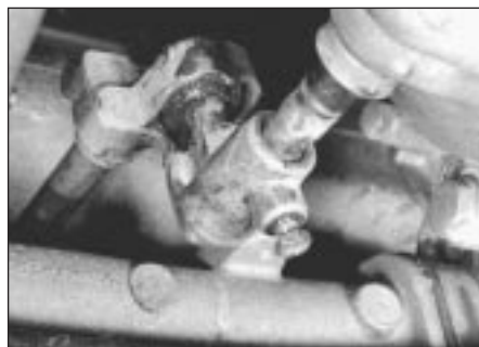
5.18 Shift rod coupling screw
