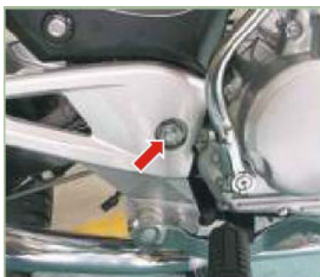
Tuerca eje basculante 8.0-10.0 Kg.-m
