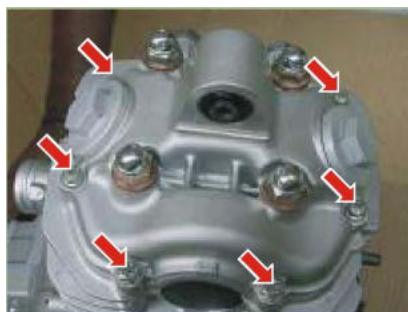
Tornillo tapa cabeza 1.1 Kg.-m
