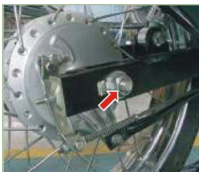
Tuerca eje trasero 8-10 Kg.-m
