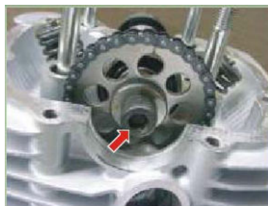
Tornillo arbol de levas 1.5 Kg.-m
