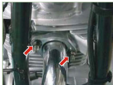
Tuercas silenciador 2-2.2 Kg.-m
