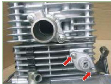
Tornillo tensor cadena 1.1 Kg.-m
