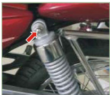
Tuerca amortiguador Trasero Arriba 3.5-4.0Kg.-m Abajo 2.7-3.0kg.-m
