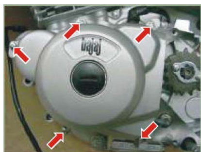
Tornillos tapa magneto 1.1 Kg.-m
