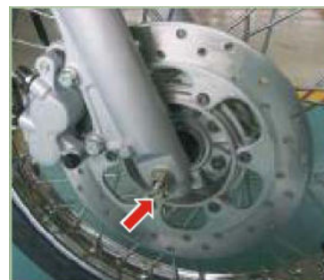
Tuerca eje delantero 4-5 Kg.-m
