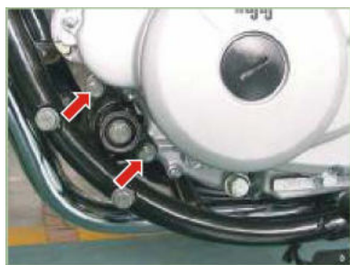
Soportes de motor M8 2.2 Kg.-m M10 2.4 kg.-m
