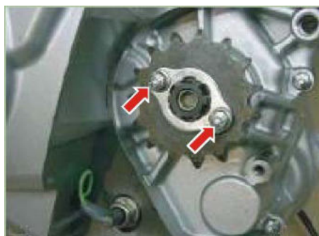
Tornillos seguro sprocket salida 1.1 Kg.-m
