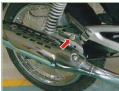
Tornillo silenciador 3.5-4.0 Kg.-m
