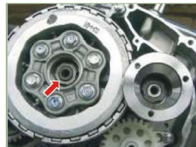
Tuerca clutch (rosca izquierda) 4.5 Kg.-m
