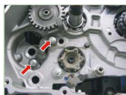
Tornillos guía de leva pedal de arranque 1.1 Kg.-m
