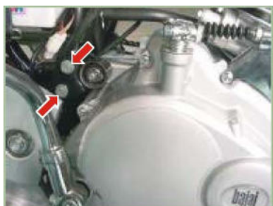
Soportes de motor M8 2.2 Kg.-m M10 2.4 kg.-m
