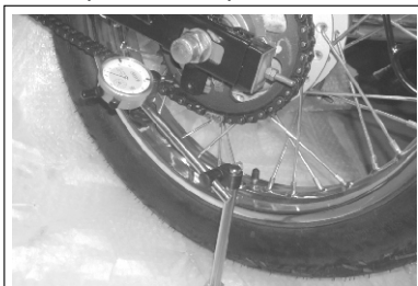
Rear Sprocket Warp
