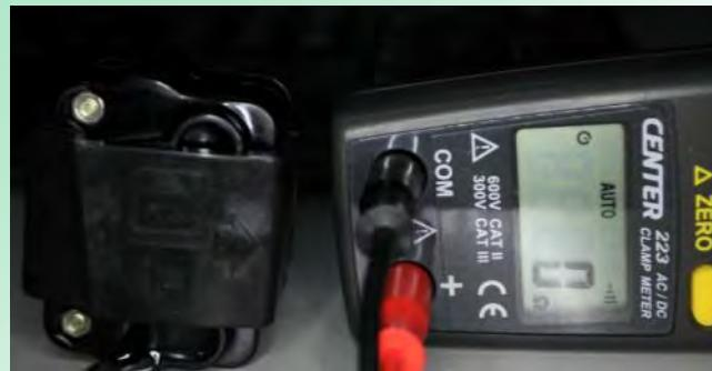
Cuando el sensor de Roll-over se inclinó sobre 75 ~ 80 grados verticalmente, conectará a tierra la señal y cortará la fuente de alimentación de la ECU
