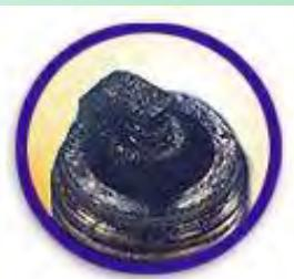
**Vista** Depósitos negros aceitosos en el aislador y los electrodos.
