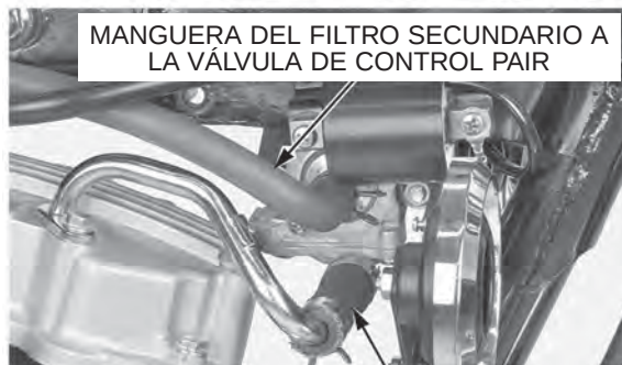
MANGUERA DEL TUBO DE SUMINISTRO DE AIRE A LA VÁLVULA DE CONTROL PAIR
