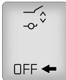
Para cambiar la puerta trasera al funcionamiento manual, oprima el interruptor en la consola central a la posición OFF (APAGADO). Aparece el mensaje: POWER LIFTGATE OFF (Puerta Trasera Eléctrica Apagada), para indicar que la puerta trasera está en funcionamiento manual.
