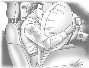
La bolsa de aire frontal del conductor está en medio del volante de conducción.
