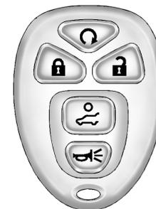
**Con visualización de Arranque remoto del vehículo y Puerta trasera eléctrica, sin similar**
