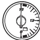
Cuando el motor no esté andando, pero la ignición esté encendida, este medidor muestra el estado de la carga de la batería en voltios DC.
