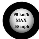
16. Si fue posible inflar la llanta desinflada a la presión de inflado recomendada, retire la etiqueta de velocidad máxima del recipiente de sellador (E) y colóquela en un sitio muy visible. La etiqueta es un recordatorio para no exceder 90 km/h (55 mph) hasta que la llanta dañada sea reparada o remplazada.
