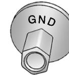
9. Conecte el otro extremo del cable negativo (-) por lo menos a 18" (45 cm) de la batería descargada, pero no cerca de las partes del motor que se mueven.
