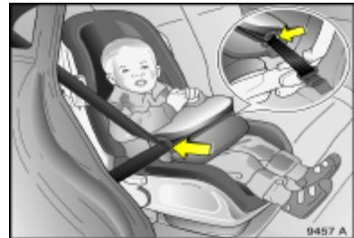
Inserte la parte diagonal y abdominal del cinturón de seguridad del vehículo en las guías del cinturón en la base de seguridad.
