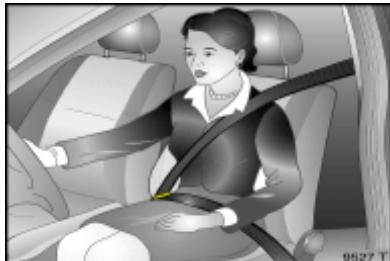
**Para abrochar el cinturón de seguridad: Jale el cinturón suavemente del riel, guiándolo sobre el hombro y trábelo en la hebilla**
