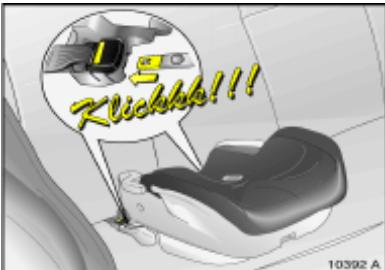
Coloque el asiento de seguridad únicamente mirando hacia adelante y cierre ambas lengüetas de manera que pueda escuchar cómo se traban en la hebilla del adaptador. Tire del asiento para verificar que el cinturón se ha colocado correctamente.
