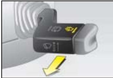
**Operación de los sistemas de limpieza de parabrisas y limpieza de faros: Jale la palanca hacia el volante**
