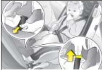
Para ajustar la longitud, jale la cinta del cinturón al frente del asiento de seguridad o aflojela levantando el seguro metálico.
