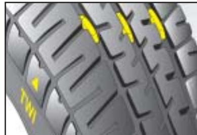
Por razones de seguridad, las llantas deben reemplazarse cuando la profundidad del dibujo se ha desgastado hasta unos 2-3 mm. La profundidad mínima permisible (1.6 mm) se ha alcanzado cuando puede verse uno de los indicadores de desgaste. Se encuentran varios indicadores de desgaste repartidos a intervalos iguales alrededor de la llanta dentro del dibujo. Se indica su posición con marcas en la cara de la llanta.
