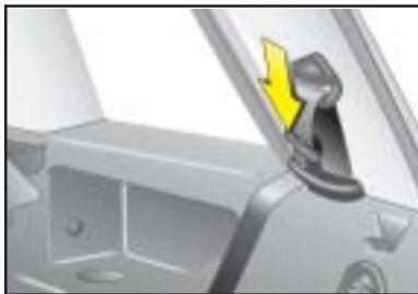
Cuando no se use, guíe el cinturón de seguridad a través del dispositivo, como se muestra en la ilustración, e inserte la lengüeta en el accesorio.
