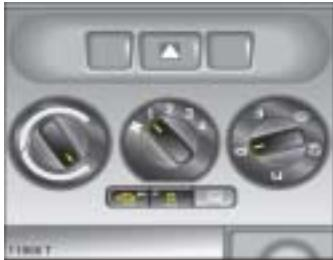
El interruptor de recirculación de aire D cambia la operación del sistema de aire acondicionado para operar en recirculación de aire.
