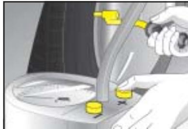
El incremento de la presión de las llantas debido al calor no debe ser reducido, ya que de otro modo la presión podría descender por debajo del mínimo permisible.
