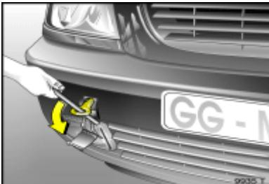
Atornille el gancho de remolque contrarreloj todo lo que pueda y use la llave de tuercas para apretarlo hasta que esté completamente horizontal.
