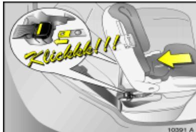
Coloque el asiento de seguridad únicamente mirando hacia adelante y cierre ambas lengüetas de manera que pueda escuchar cuando se traban en la hebilla del adaptador. Tire del asiento para verificar que el cinturón se ha colocado correctamente.
