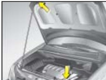
Para mantener el cofre en posición abierta, inserte la varilla de soporte localizada en ángulo recto sobre el radiador en la ranura plastificada en el lado interior del cofre.
