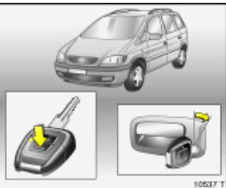
El cambio de baterías debe realizarse en menos de 3 minutos, de otro modo, la unidad de control remoto deberá ser resincronizada.
