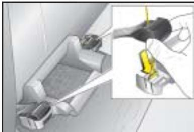
Coloque el cojín ajustador de altura en uno de los asientos de la segunda fila. Presione el lado redondeado del adaptador entre el respaldo y la banca del asiento, como se muestra en la ilustración y enganche la hebilla de ambos en el adaptador.
