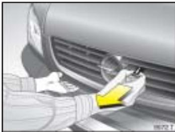
Para abrirlo por completo, coloque la manija de seguridad ligeramente hacia la derecha del centro como si estuviera viéndola desde el frente. Levante hacia arriba y abra el cofre.
