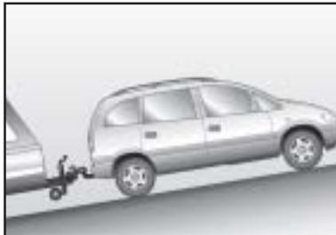
Si es necesario aplicar completamente el freno, particularmente para asegurar el frenado en una distancia corta cuando arrastra un remolque, presione el pedal de frenos tan fuerte como le sea posible.
