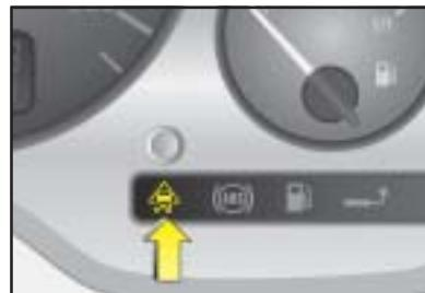
Si la luz se enciende mientras conduce, ha ocurrido una falla en el sistema. Puede continuar conduciendo. Dependiendo de la aceleración y las condiciones del camino, la estabilidad del vehículo podría afectarse como resultado del derrape de las llantas.
