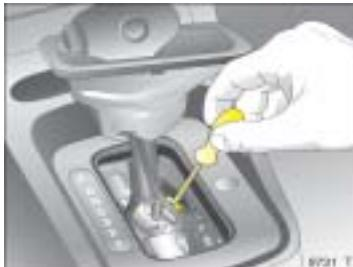
Si la batería no es la causa de la falla, libere la palanca de cambios:
