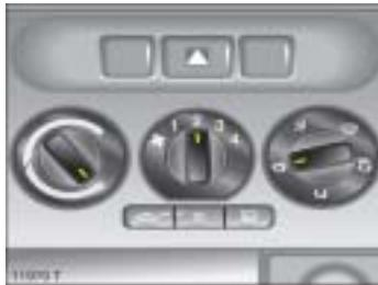
El interruptor de temperatura en el medio del rango de ajuste: flujo de aire más cálido al área de los pies y aire más frío en la zona superior, con aire caliente saliendo de las rejillas de ventilación laterales y aire frío saliendo de las rejillas centrales.
