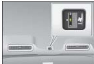
Hay una perilla adicional para el ventilador
