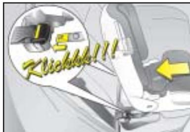
Coloque el asiento de seguridad únicamente mirando hacia adelante y cierre ambas lengüetas de manera que pueda escuchar cuando se traban en la hebilla del adaptador. Tire del asiento para verificar que el cin-
