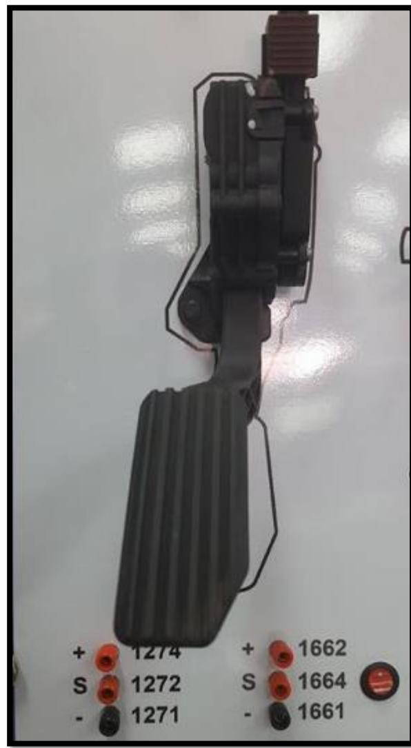
Figura 30. Pedal de aceleración
