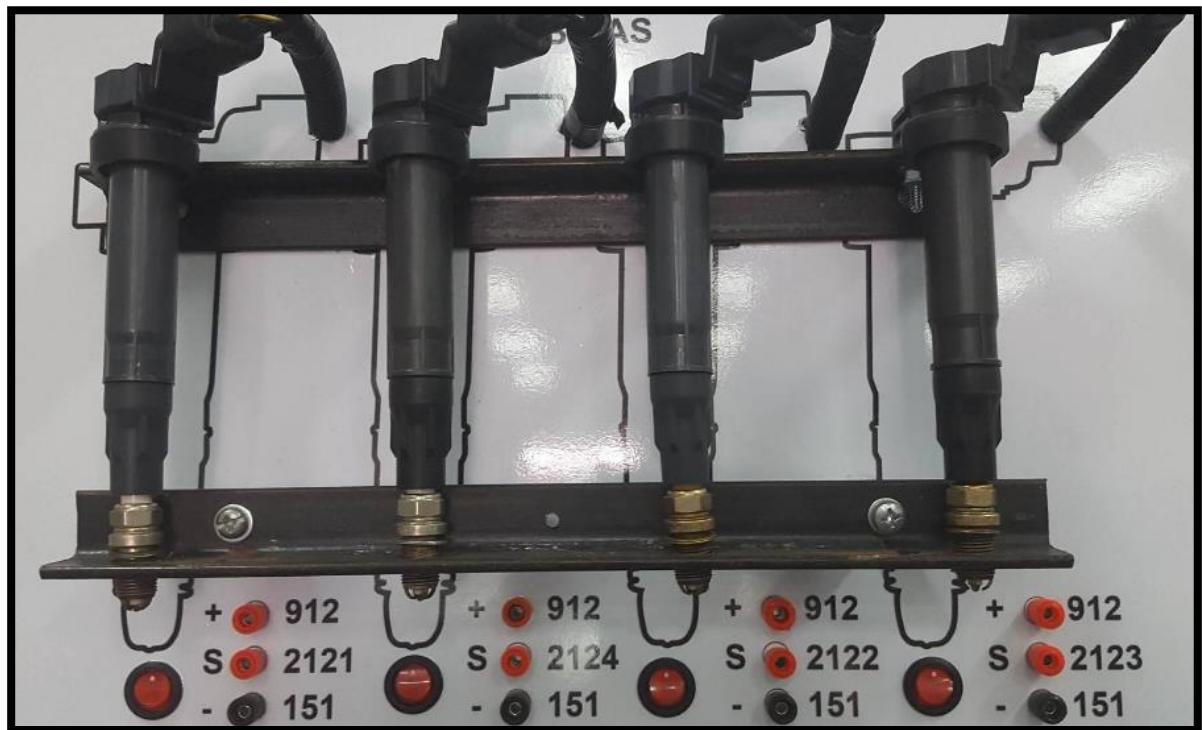
*Figura 26. Bobina de encendido*
