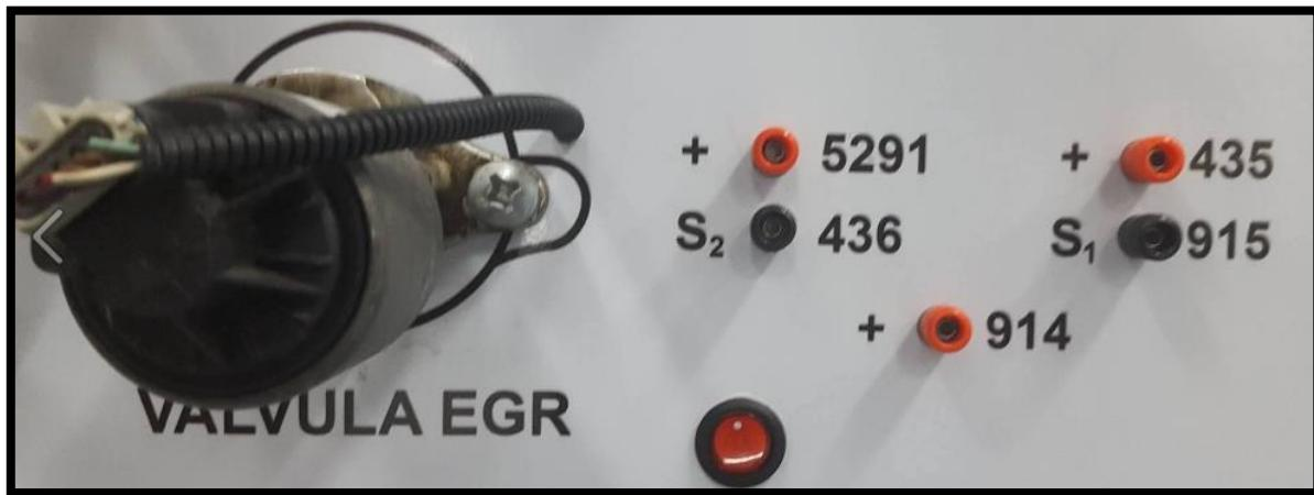
Figura 9. Sistema de recirculación de gases de escape
