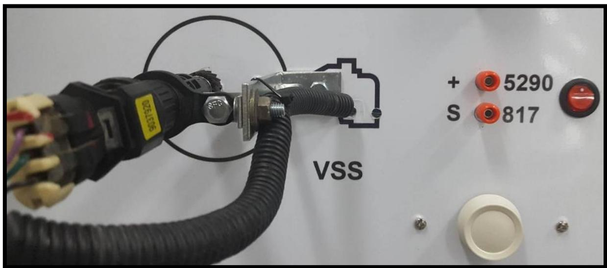
*Figura 7. Sensor de velocidad del vehículo (VSS)*
