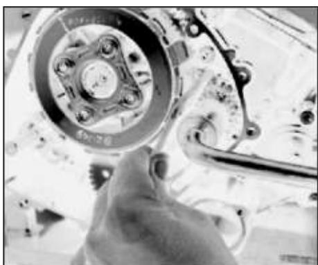
Utilizar la herramienta especial F41AJA54 y el encaje especial para la tuerca del embrague
