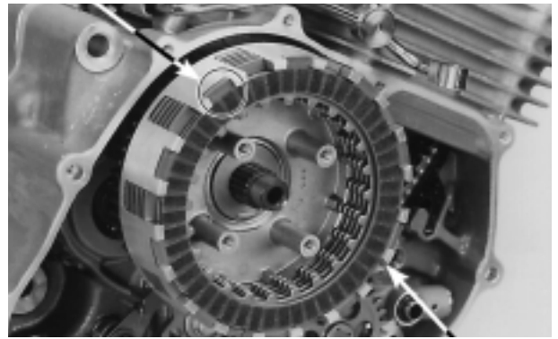
DISCO DEL EMBRAGUE EXTERNO MARCA "OUT SIDE" CUBO DEL EMBRAGUE
