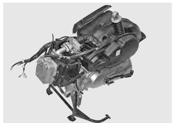
Compruebe el soporte de montaje del motor de daños o deterioro y reemplace si es necesario.
