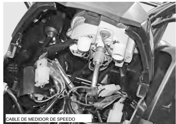
Desconectar los conectores de cable medidor velocímetro.
