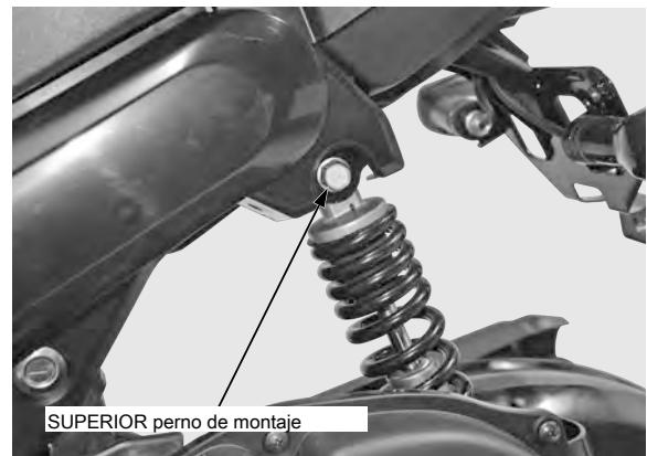
Retire la tuerca de montaje del motor y extraiga el perno de montaje desde el lado izquierdo.
