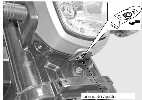
Retire el CONJUNTO faro (página 2-2). Retire la unidad de los clips y los faros. La instalación es en el orden inverso al desmontaje. Ajustar el enfoque de los faros (página 3-16).
