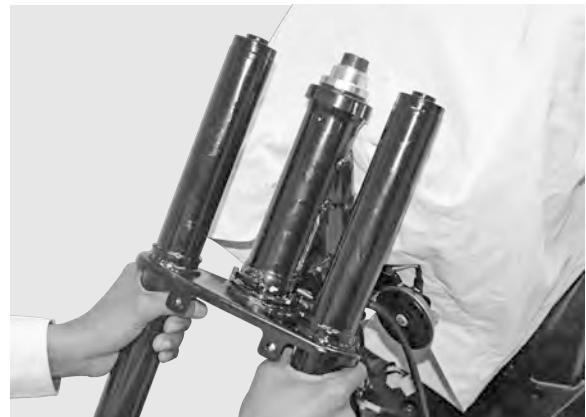
Temporalmente aflojar la tuerca de ajuste completamente, a continuación, volver a apretar la tuerca de ajuste con el par especificado.
