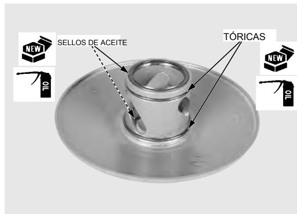
Instalar la cara impulsada móvil sobre la cara impulsada. Aplique grasa a los pasadores de guía e instalarlos en los orificios de la cara impulsada.
