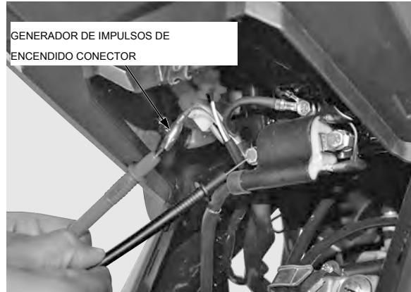
**ENCENDIDO PRIMARIA Y SECUNDARIA resistencia de la bobina**
