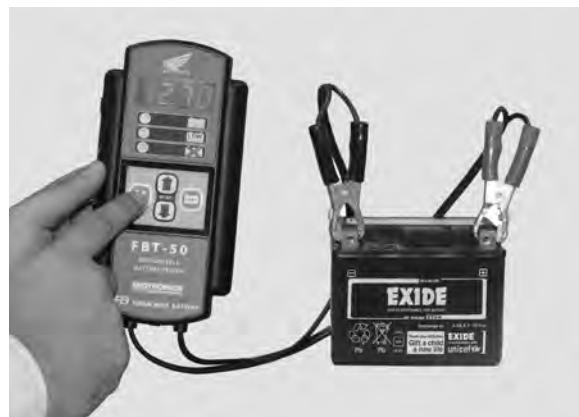
Para cargar la batería a prueba la prensa à € botón œTESTâ €.
