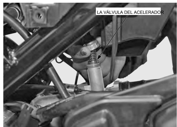
Instalar la válvula de mariposa en el cuerpo del carburador. Apretar la parte superior del carburador segura. Después de la instalación compruebe que no haya fugas de combustible. Realice el siguiente ajuste:
