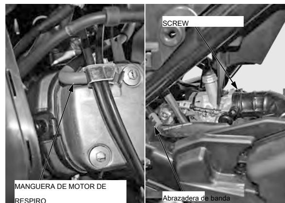
Desconectar el tubo de ventilación de caja de transmisión de la carcasa del filtro de aire.
