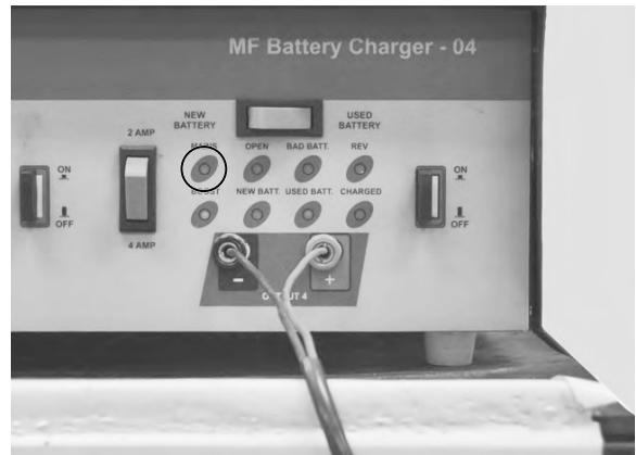
LED principal será seguido por LED amarillo (Para Nueva batería) o LED azul (Para batería utilizada) indica que la batería se está cargando correctamente.
