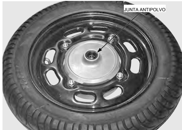
Inserte la cabeza removedor de cojinete en el cojinete. Del lado opuesto instalar el eje extractor de rodamientos y conducir el cojinete de la rueda desde ambos lados (izquierdo y derecho).
