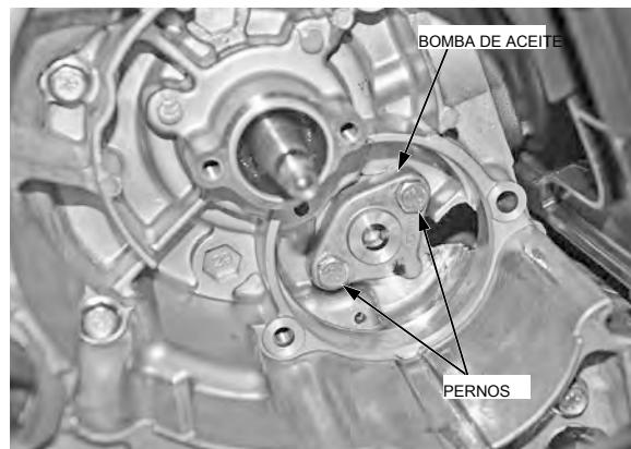
Instalar el engranaje de la bomba de aceite y el eje del engranaje en la bomba de aceite.
