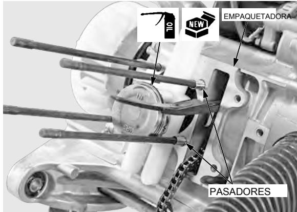
Ruta la cadena de levas a través del cilindro e instalar el cilindro sobre el pistón, mientras que la compresión de los anillos de pistón con los dedos. Instalar el siguiente:
