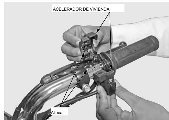
Instalar el tornillo y apriete el tornillo hacia delante en primer lugar, a continuación, el tornillo trasero.
