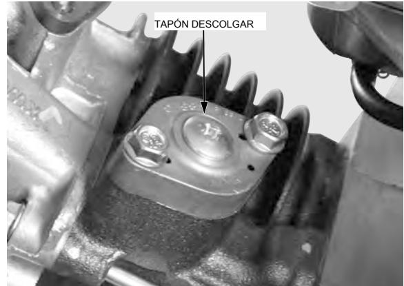
Girar el eje tensor de las agujas del reloj con la herramienta de tope para retraer el tensor, a continuación, insertar el tapón completamente para mantener el tensor en la posición completamente retraída.
