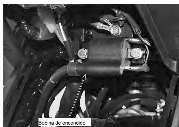
**ENCENDIDO DEL GENERADOR DE IMPULSOS pico de tensión****NOTICE**
