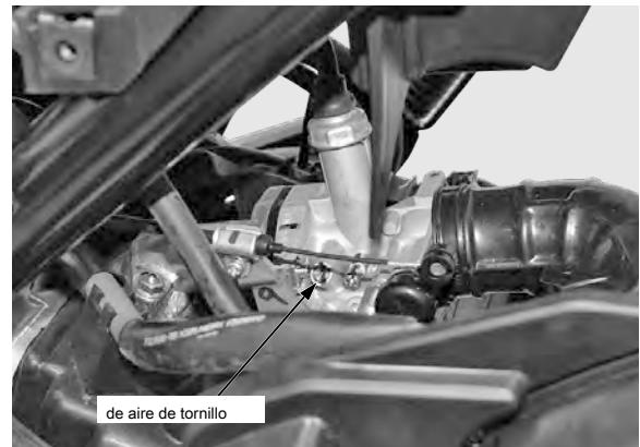
1. Girar el tornillo de aire hasta que se asiente ligeramente, luego de vuelta hacia fuera a la especificación dada.
