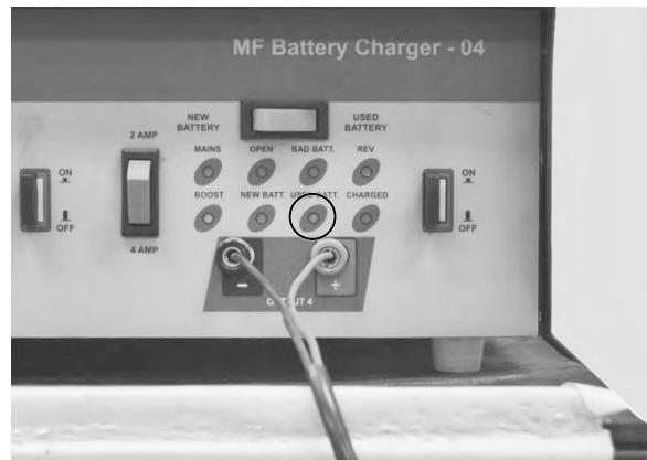
El LED verde indica, la batería está completamente cargada. Una vez más comprobar la tensión de la batería (página 15-3).
