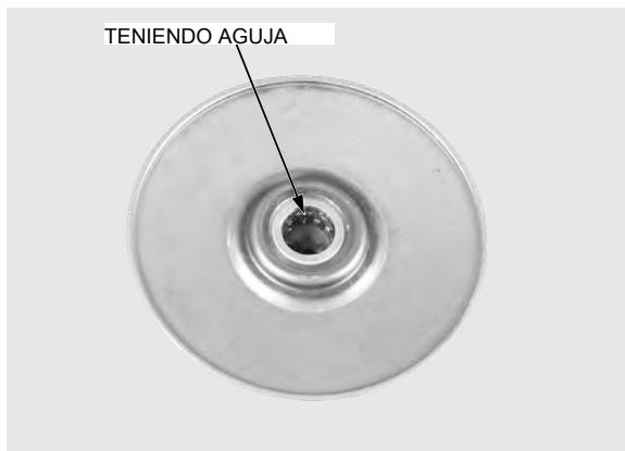
Retire el anillo de retención y conducir el cojinete de bolas fuera de la cara impulsada.
