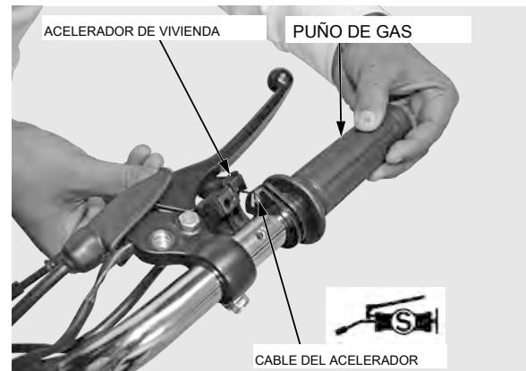
Instalar la carcasa de regulación, mientras que la alineación de la clavija de posición en la carcasa con el orificio en la barra de manivela.
