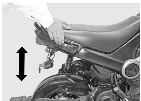
Levante la rueda trasera del suelo mediante la colocación del vehículo sobre el caballete central.
