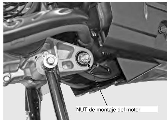
Retire el motor del bastidor.
