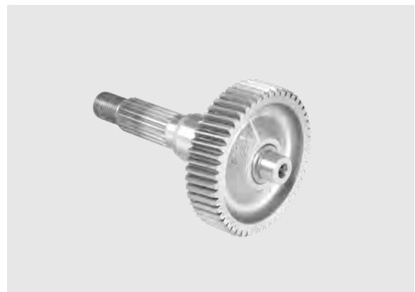
Compruebe el eje y el contador de engranajes de engranajes secundario para el desgaste excesivo, daños o signos de convulsiones.
