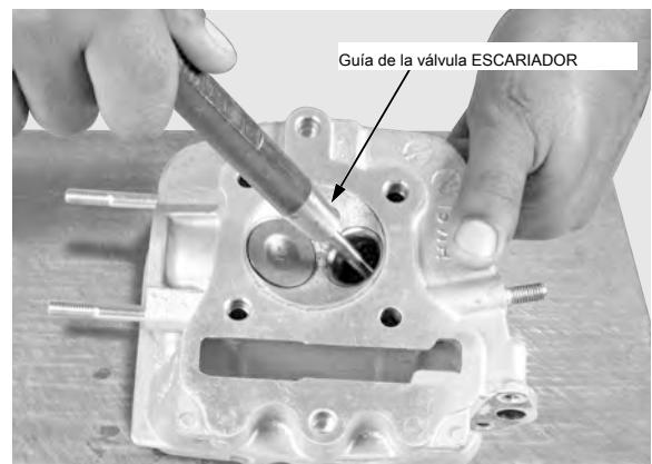
Si la holgura el vástago y la guía excede los límites de servicio, determinar si una nueva guía con dimensiones estándar traerá la holgura dentro de la tolerancia. Si es así, vuelva a colocar las guías según sea necesario y resma de encajar.
