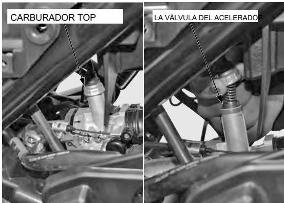
Retire el cable del acelerador de la válvula reguladora mientras comprime el resorte de válvula de mariposa.
